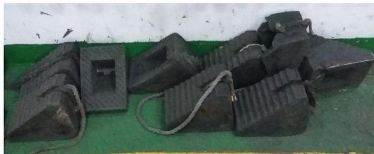
*Fig. 13: Calzos grandes para carga rodada pesada*
