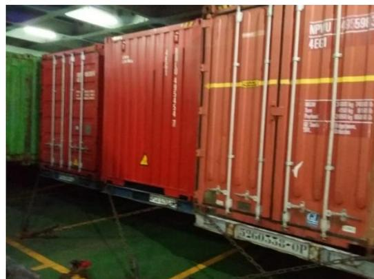
*Fig. 24: Roll-trailers trincados en cubierta*
