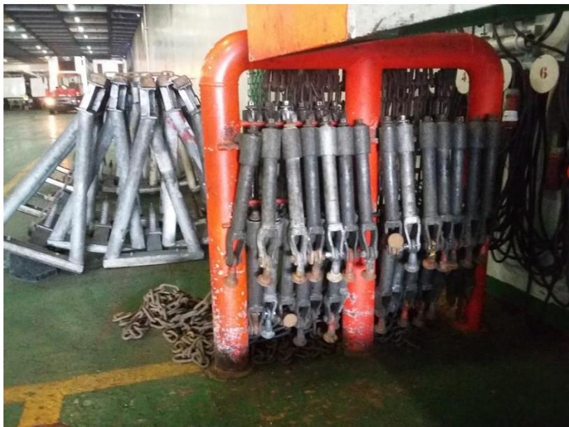
*Fig. 29: Elementos de sujeción estibados para uso diario*
