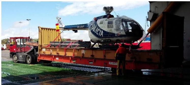
*Fig. 25: Primer Oficial comprobando el trincaje de un helicóptero listo para embarcar*
