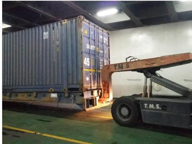
*Fig. 23: Descarga de contenedor sobre roll-trailer*
