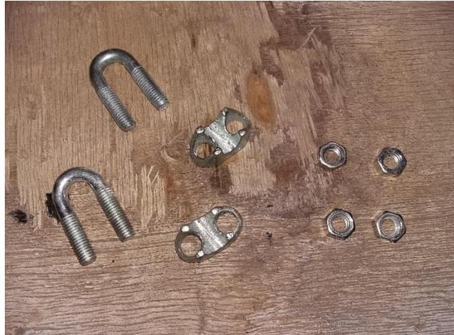
*Figs. 26 y 27: Elementos de refuerzo del trincaje*
