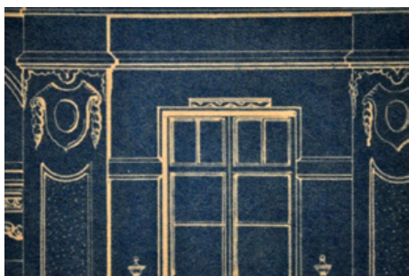
Figura 11. Moldura en cintas del dintel. Ornato Público. Unid. Instal.76-86. Archivo Municipal de S/C de Tenerife. Arqto. Domingo Pisaca. Foto: el autor.
