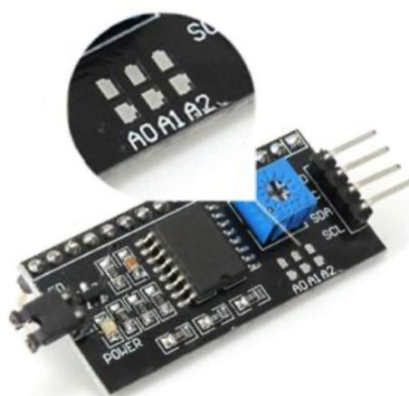
Figura 49: Adaptador I2C y pines de dirección 15
