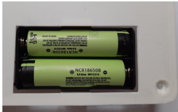
Figura 57: Montaje de pilas en la base del reloj
