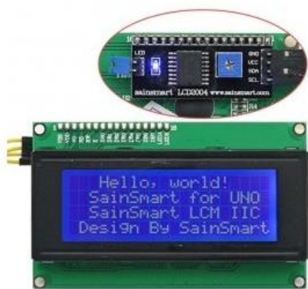
Figura 48: Pantalla LCD 4x20 i2C 14
