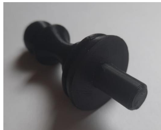
Figura 24: Base de peón con vástago (impresión 3D)
