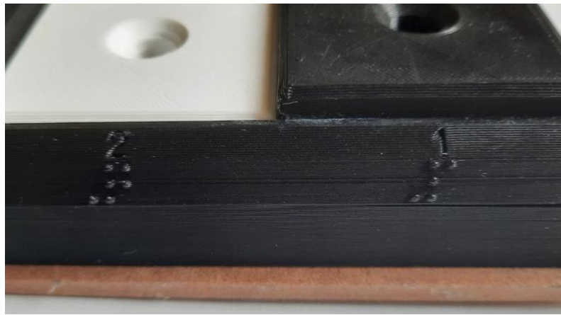
Figura 29: Numeración en braille (impresión 3D)
