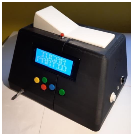
Figura 3: Reloj de ajedrez adaptado para personas con discapacidad visual
