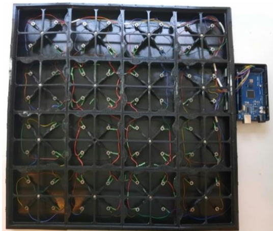
Figura 34: Matriz de pulsadores en la base del tablero
