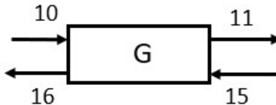
Figura 19: Volumen de control para el balance de exergía en el condensador. Fuente: Elaboración propia.
