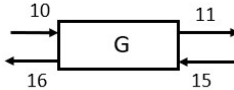
Figura 11: Volumen de control para el balance de energía en el condensador completo. Fuente: Elaboración propia.
