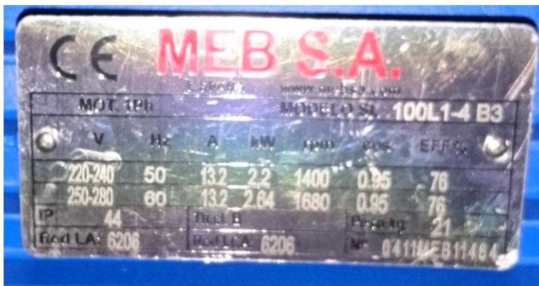
Figura 5-11. Placa de características del motor eléctrico principal.
