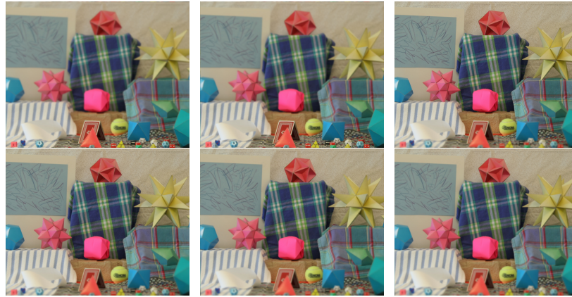
FIGURA 5.1: Focal stack generado a partir de una imagen de Middlebury [124], desde el enfoque más cercano (arriba-izquierda) al más lejano (abajo-derecha).
