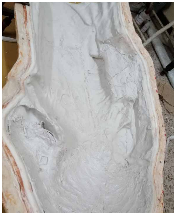
Fig.78- Aspecto del vaciado de una de las caras del molde.
