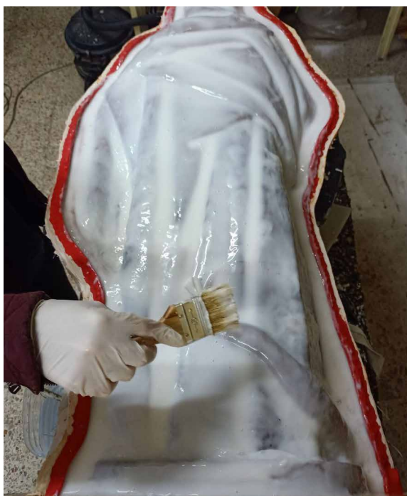
Fig.63- Aplicado de la primera capa de silicona. Pincelado de toda la superficie.
