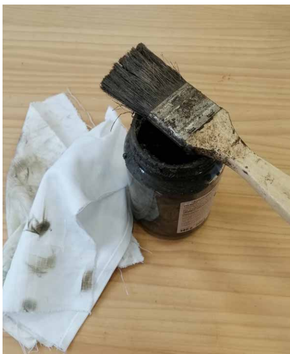
Fig.113- Preparación de la pátina con cera de abeja natural, trementina y pigmento sombra natural.
