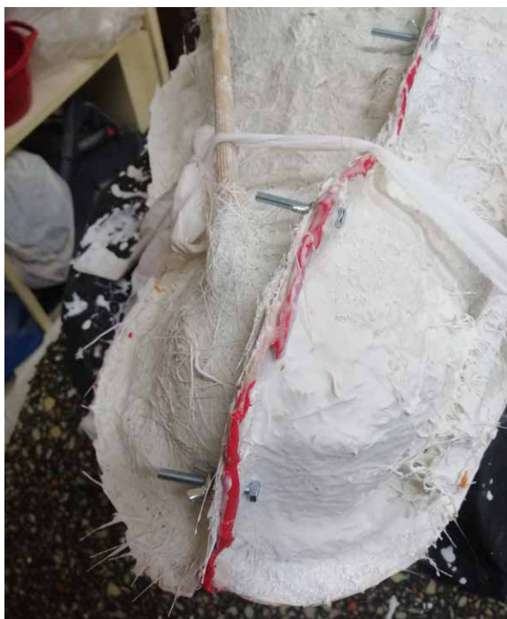
Fig.61- Colocación de los tornillos roscados con las palometas.
