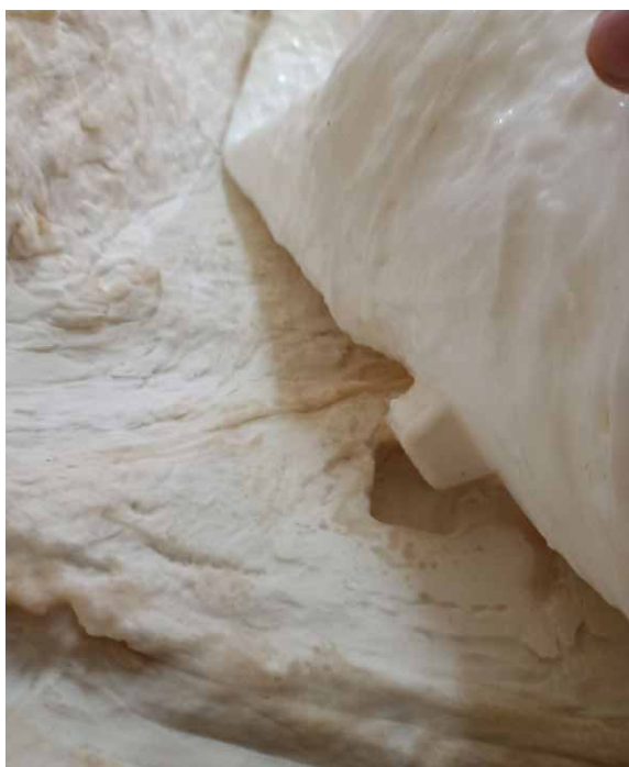
Fig.69- Encaje de la película con la madreforma de fibra gracias a las llaves.
