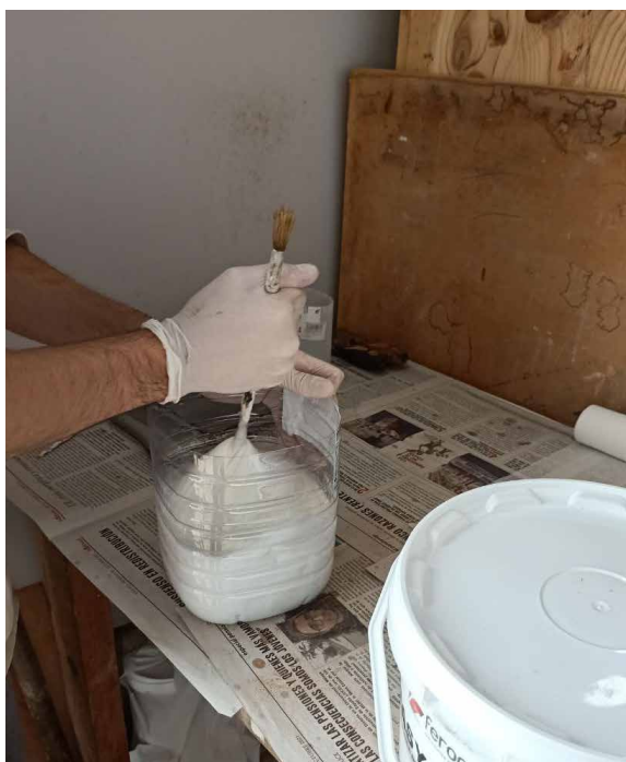
Fig.49- Preparación de la silicona con su respectivo catalizador. Esta silicona cataliza a las 4 horas facilitando la labor.
