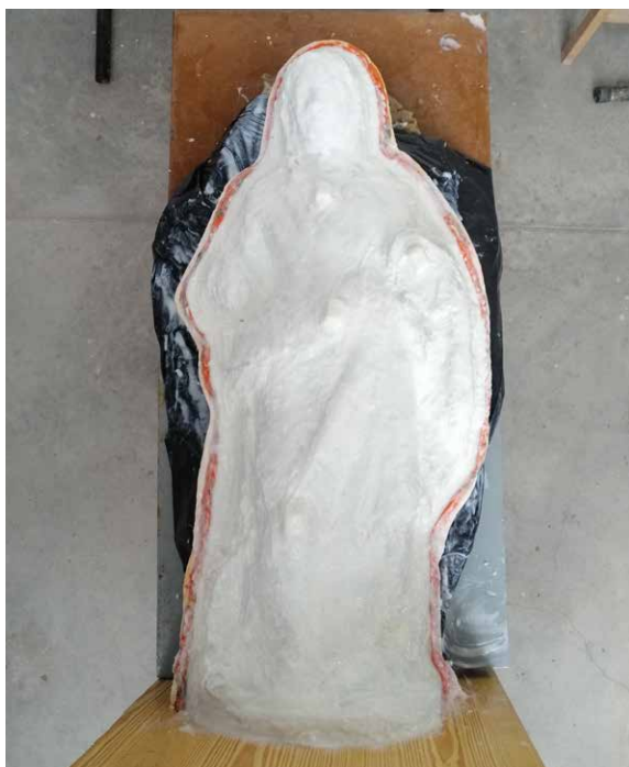
Fig.53- Visión de la película de silicona tras la aplicación de la segunda y tercera capa.
