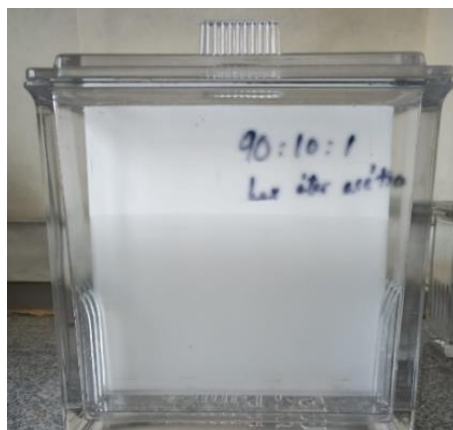
Ilustración 3. Cubeta para placas TLC conteniendo hexano:etil éter:ácido acético (90:10:1, v/v/v). Foto del autor.
