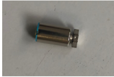
Figura 47. Motor vibrante de corriente continua
