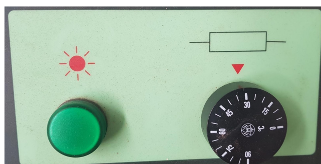
Figura 6.10: Indicador luminoso y termostato.
