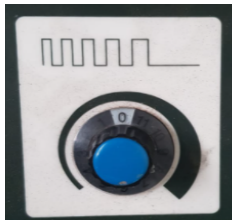
Figura 6.12: Codificador rotatorio encargado de variar la velocidad del rodillo interior.
