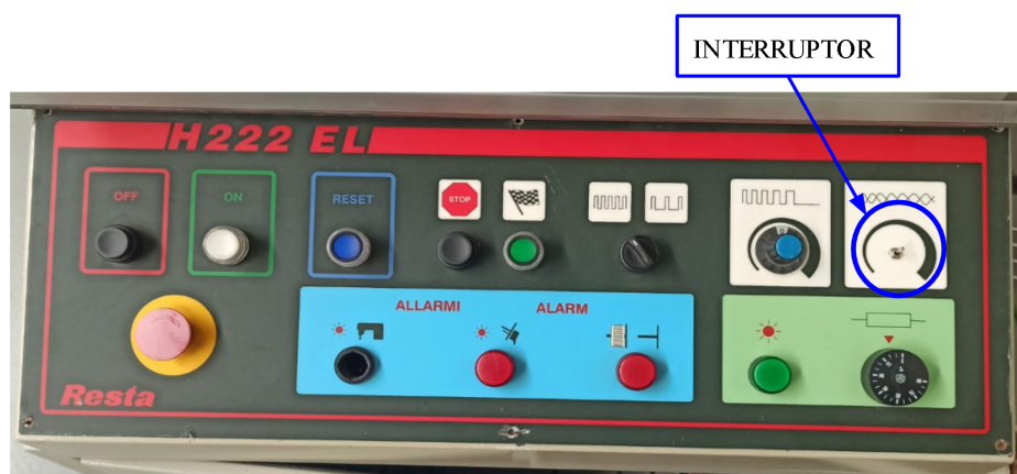
Figura 8.2: Interruptor conectado a la señal I0.7 incorporado al panel de control.
