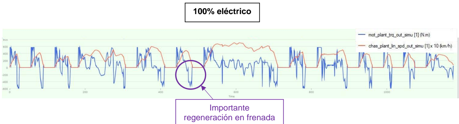
Figura 4.4 Justificación en la reducción de consumo del vehículo 100% eléctrico respecto a la arquitectura convencional en la Línea 253. Curva de par motor (azul) y perfil de velocidad (rojo). Fuente Propia
