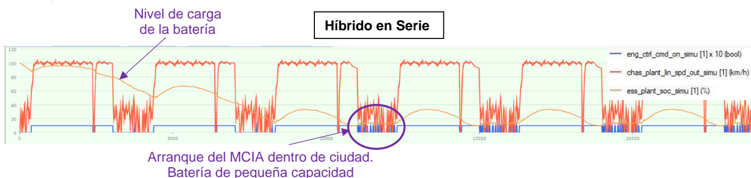
Figura 4.10 Operación del vehículo híbrido en serie anterior en la Línea 110 SC-Costa Adeje. Nivel de carga de la batería (amarillo), perfil de velocidad del vehículo (rojo) y señal de arranque del MCI (azul). Fuente Propia
