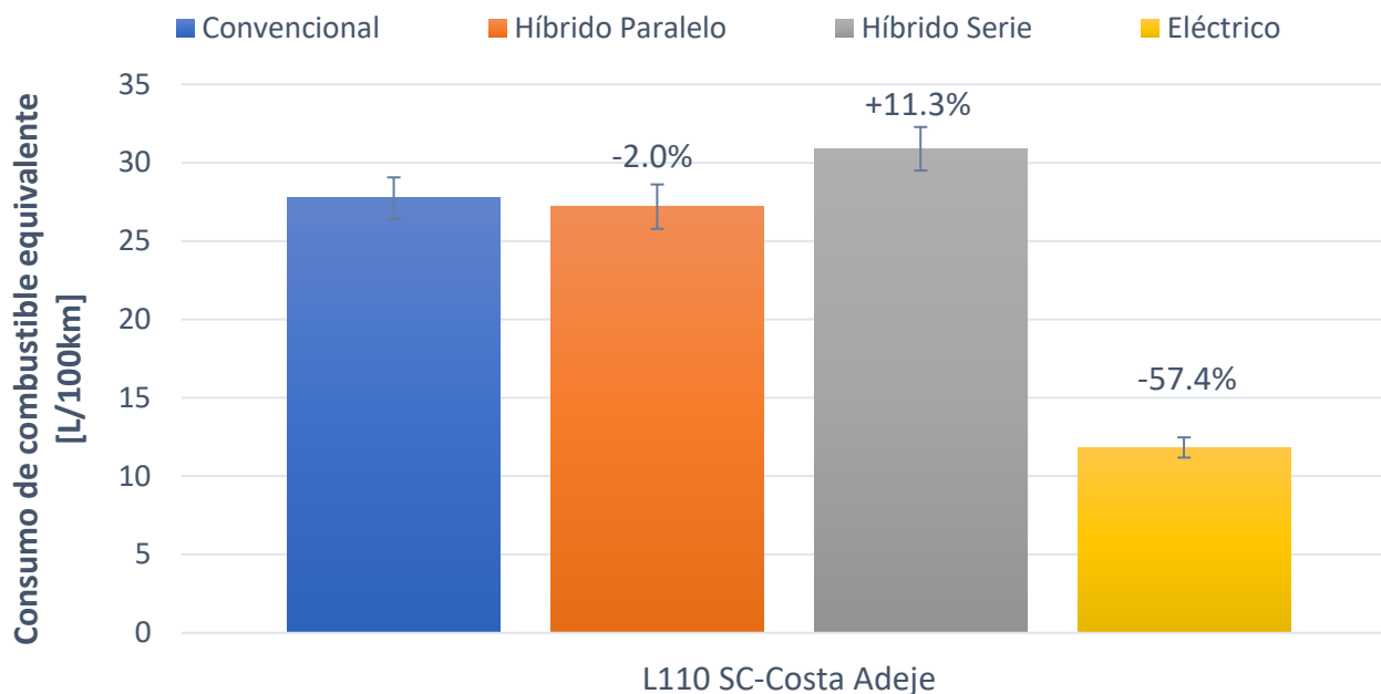
Figura 4.12 Comparación de consumo de combustible equivalente entre configuraciones para la Línea 110 SC-Costa Adeje. Fuente Propia
