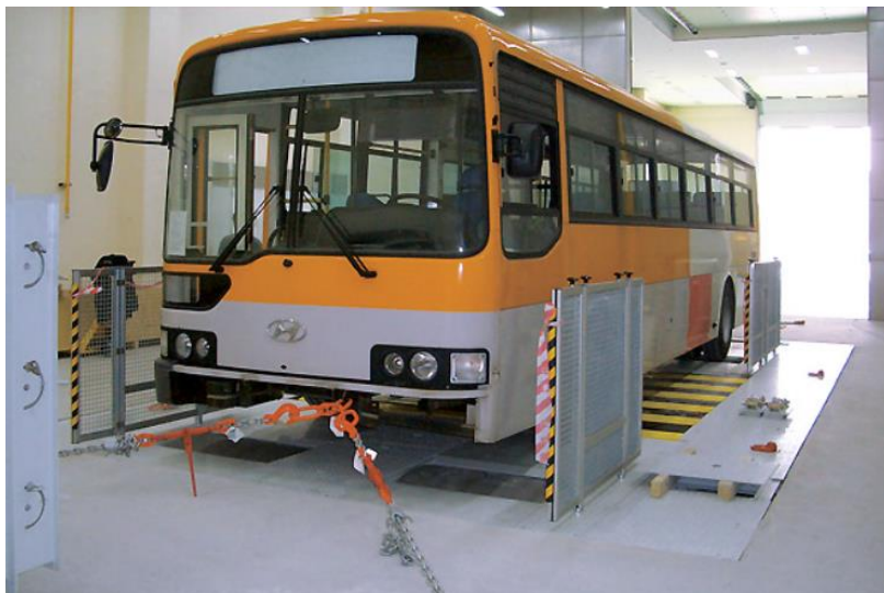
Figura 2.3 Ensayo de una guagua sobre banco de rodillos [12].
