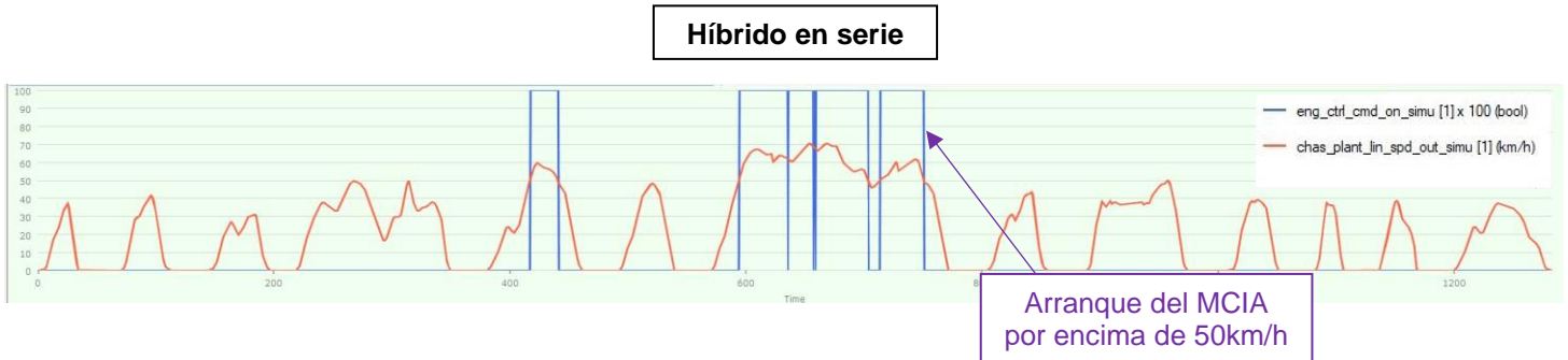
Figura 4.3 Justificación en la reducción de consumo del híbrido en serie respecto a la arquitectura convencional en la Línea 253. Señal de encendido MCIA (azul) y perfil de velocidad (rojo). Fuente Propia
