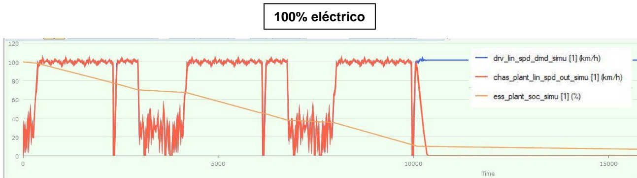
Figura 4.17 Operación del vehículo 100% eléctrico en la Línea 110 SC-Costa Adeje. Nivel de carga de la batería (amarillo), perfil de velocidad del vehículo (rojo) y demandada (azul). Fuente Propia
