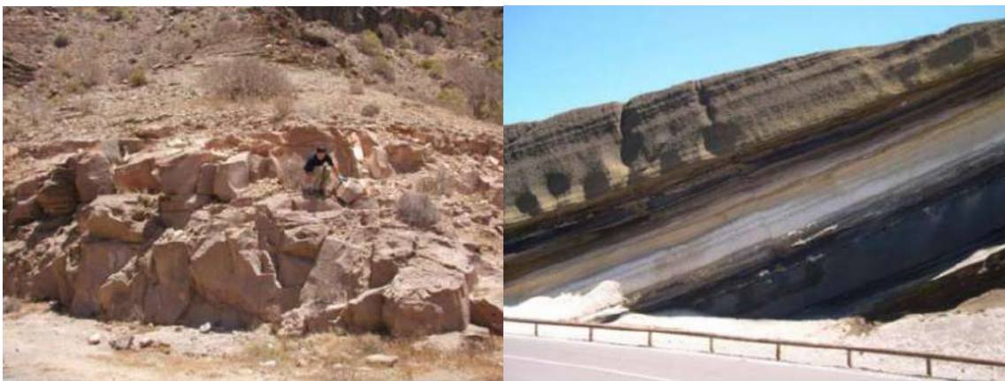
Ilustración 6. Ejemplo de Materiales piroclásticos, Ignimbritas y tobas (izquierda) y materiales piroclásticos sueltos o débilmente cementados (derecha). Fuente: Guía para la planificación y realización de estudios geotécnicos para la edificación en la Comunidad Autónoma de Canarias.
