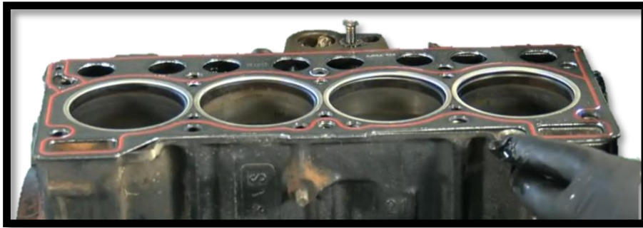
Ilustración 46: Junta de culata del “C1J”. Fuente: Trabajo de campo.
