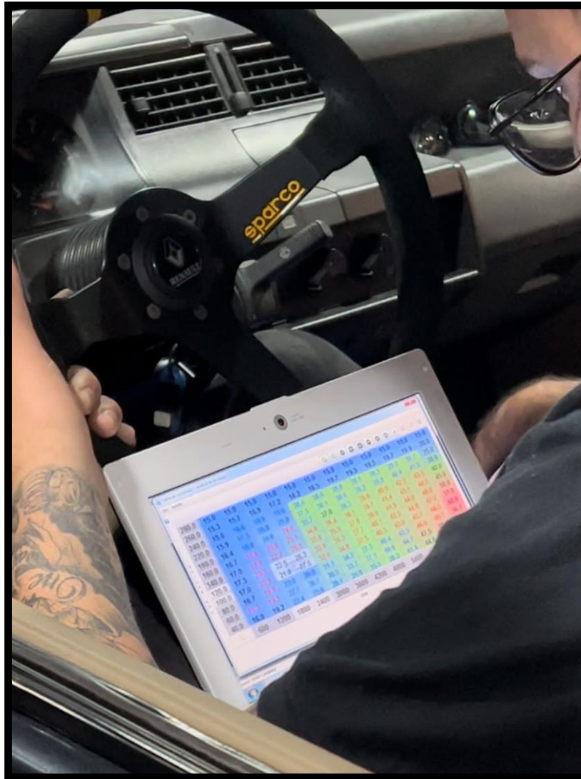
Ilustración 77: Ajustes de avance de motor. Fuente: Trabajo de campo.
