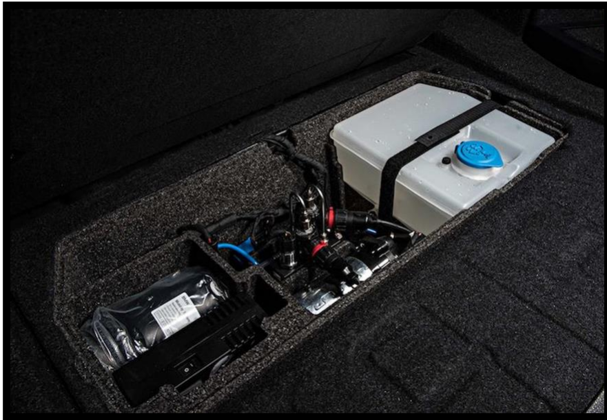
Ilustración 81: Depósito de acumulación de agua. Fuente: [36]
