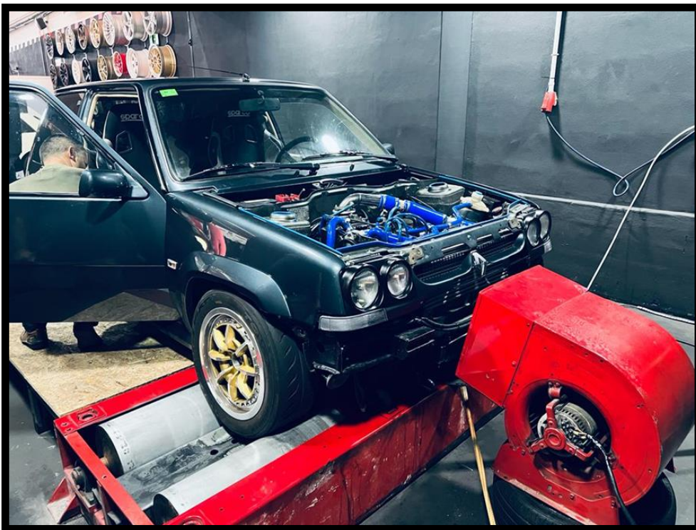
Ilustración 74: Pruebas de inyección de agua de motor "C1J". Fuente: Trabajo de campo.
