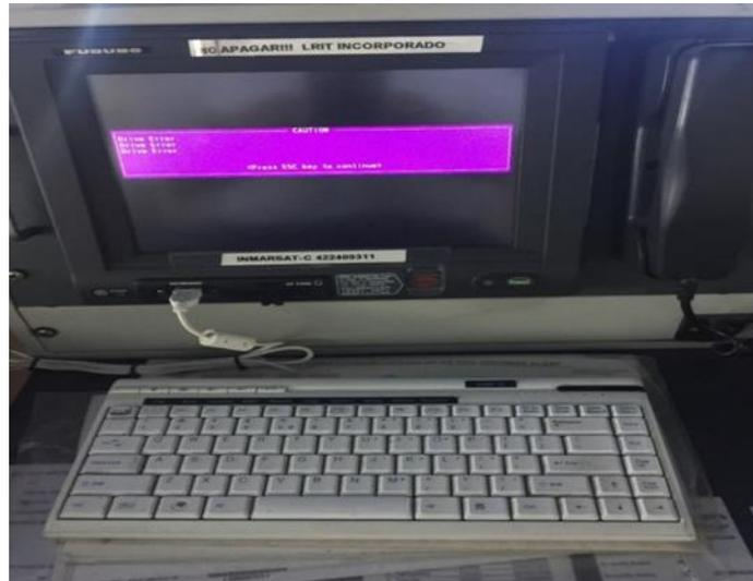
Figura 7.1: Terminal Inmarsat-C a bordo de Volcán de Tamasite.
