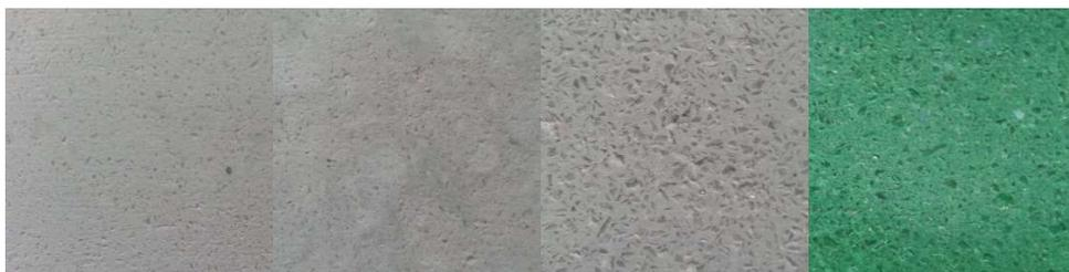
*Figura XXII. De izquierda a derecha: Acabados de las series 1, 2, 3 y 4, tras haber sido sometidas a proceso de lijado (ap. 7.3.1)*
