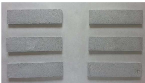
*Figura XXXVI. Serie 3 tras el proceso de lijado*
