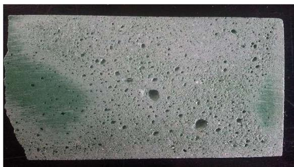
*Figura XXIX. Burbujas de aire en la parte inferior de la probeta 6-3*
