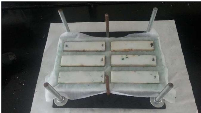
*Figura XXV. Molde Polietileno preparado para introducir en la estufa (a falta de la placa de hierro superior)*
