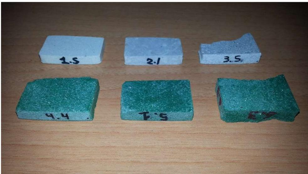
Probetas fracturadas para efectuar el ensayo de dureza Knoop
