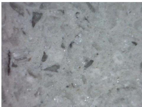
*Figura LIV. Probeta 3-3, donde se pueden apreciar ambas tonalidades de vidrio*
