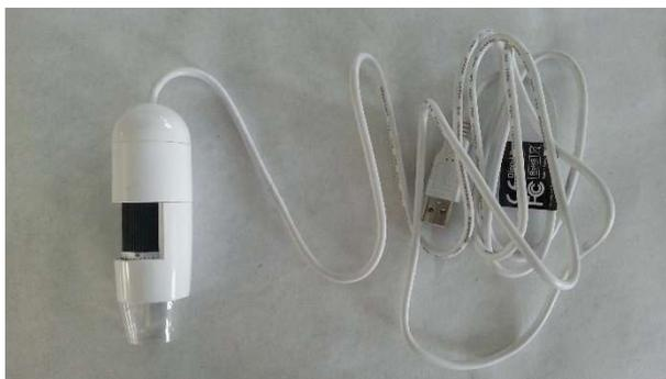
*Figura XXX. Microscopio óptico Dino-Lite*
