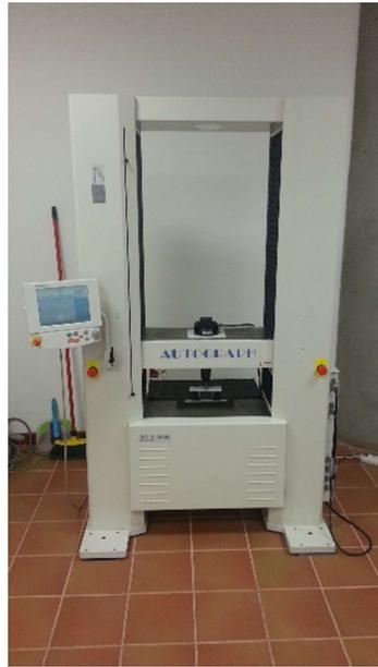
*Figura XXXIX. Máquina de ensayos mecánicos AG-IS 50 kN Shimadzu Autograph*
