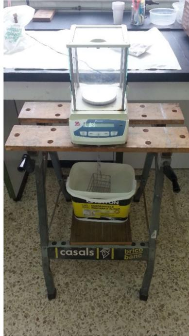
*Figura XXXI. Pesa y balanza hidrostática*
