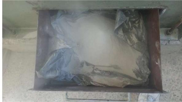
*Figura VIII. Vidrio a la salida de la trituradora de rodillos*
