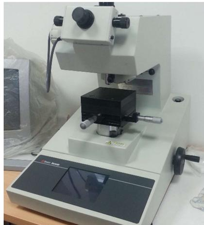
*Figura XLIX. Microdurómetro Struers Duramin*
