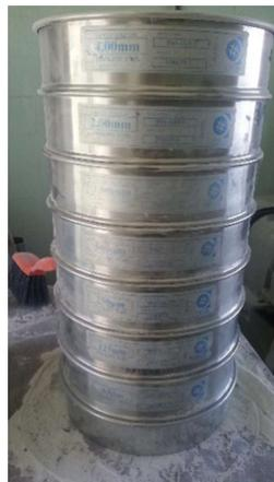
*Figura IX. Tamices utilizados para el proceso de separación del polvo de vidrio*
