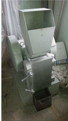
*Figura VI. Trituradora de mandíbulas*
