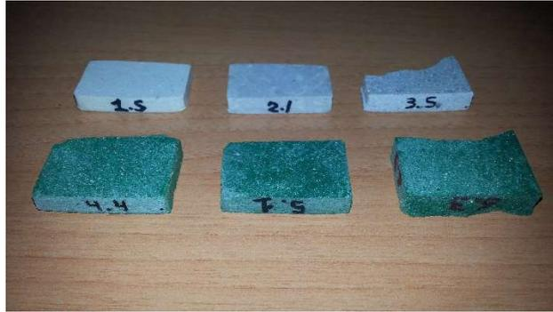
*Figura XLVIII. Piezas fracturadas tras el acondicionamiento*
