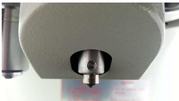
*Figura XLII. Identador de diamante Knoop para el ensayo en piedra*
