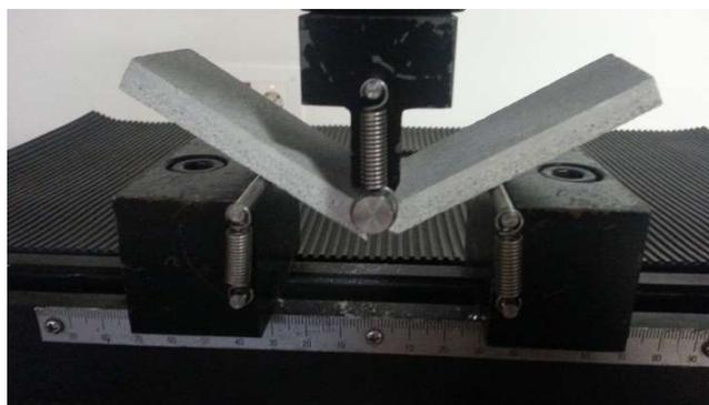
*Figura XLI. Pieza 3-2 justo tras quebrarse durante el ensayo*
