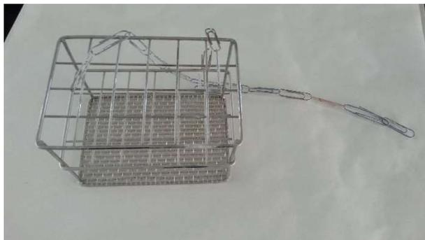
*Figura XXXII. Instrumento para realizar la pesada bajo el agua*
