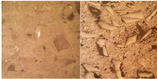
*Figura XLVII. Comparativa microscópica de probeta 3-5 sin pulir (izquierda) y pulida (derecha)*
