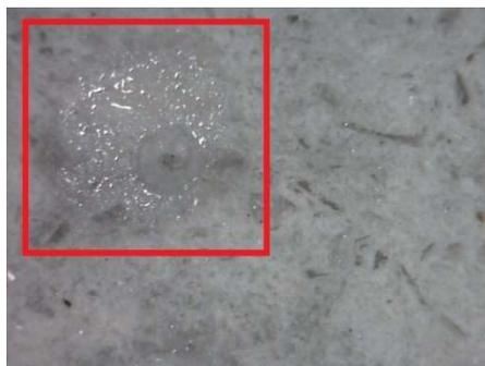
*Figura LX. Probeta 2-2, en la que se aprecia la resina fuera de la masa*
