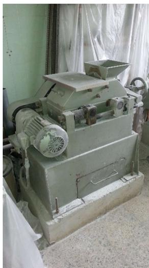
*Figura VII. Trituradora de rodillos*
