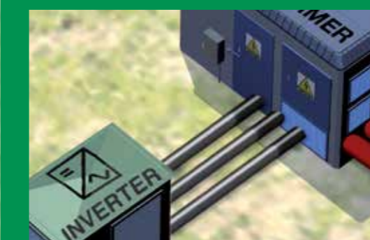
5 Instalación BT AC hasta el transformador
