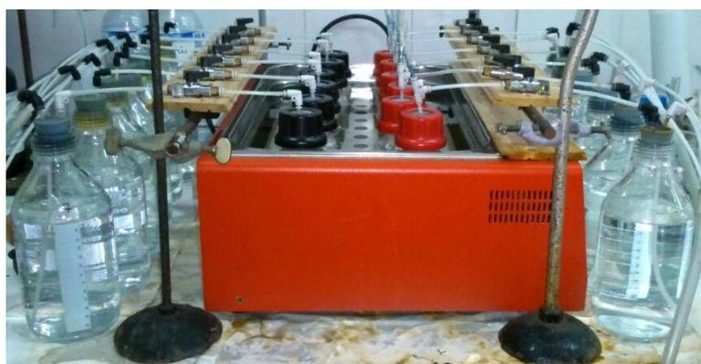
**Figura 3. 2. Set de biodigestores**
