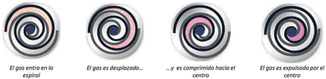
Figura 26. Esquema bomba Scroll (Fuente pública)
