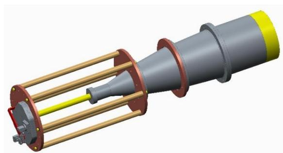
Figura 14. Montaje estructura fría receptor (Fuente propia)
