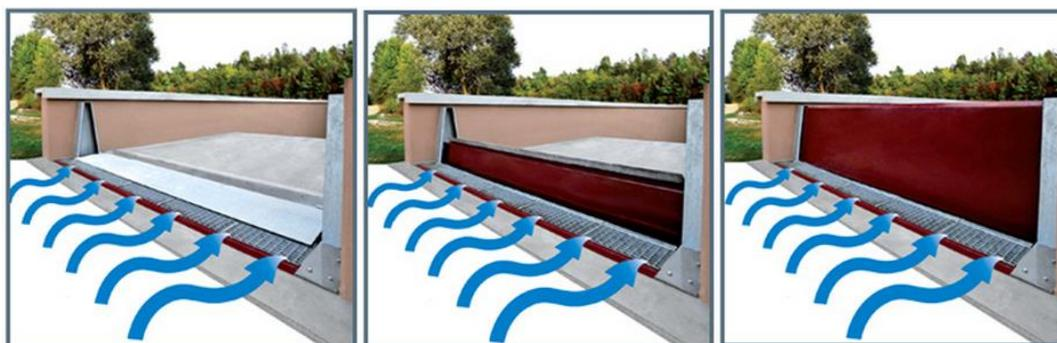
Figura 6-2. Funcionamiento del sistema Ranagalle. (Ranagalle)
