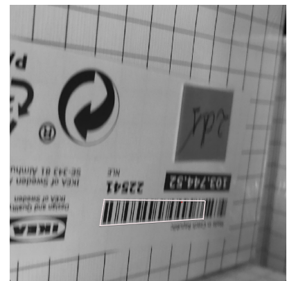
(c) Tercer imagen de la secuencia. Punto de referencia se ha extrapolado de la imagen anterior. El código presenta desenfoco y se ha realizado una detección parcial, por lo que esta imagen se descartaría.
