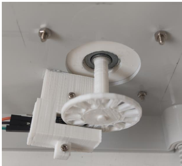
Figura 56: Eje unido al tubo mediante los rodamientos.
