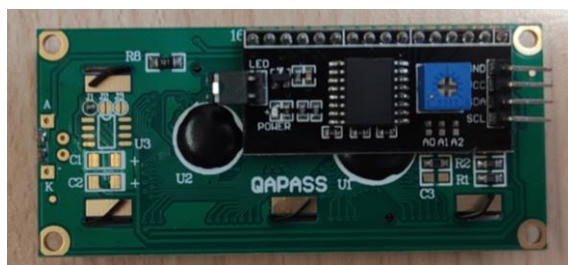
Figura 13: Parte trasera pantalla LCD más el módulo I2C.
