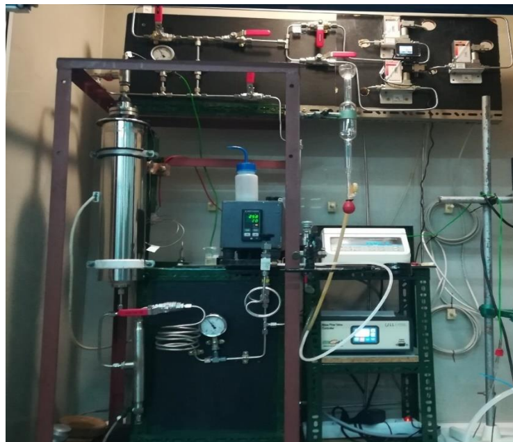
Figura 3.4. Foto de sistema de hidrogenación catalítica de CO 2
