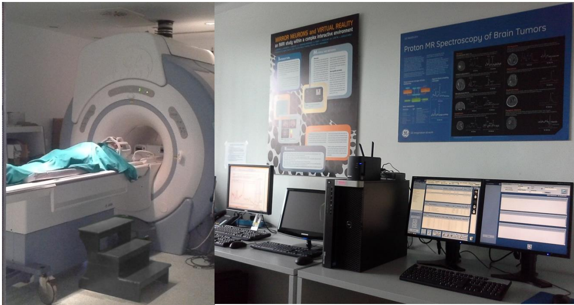
Figura 3.1. Equipos del SRMIB en SEGAI-ULL. A la izquierda, GE Signa Excite HD3.0T. A la derecha, consolas y equipos de procesamiento de datos.
