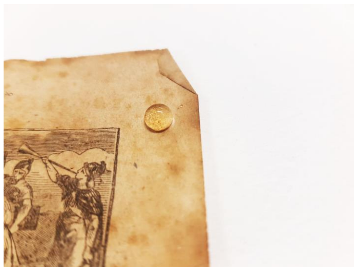
Imagen 57. Prueba de absorción de humedad
