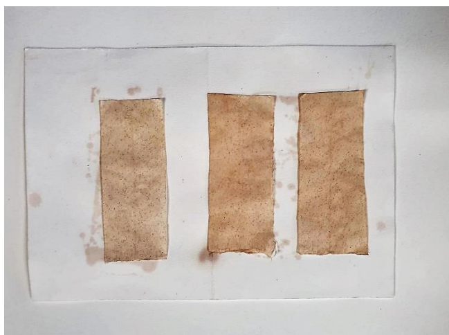
Imagen 62. Puesta a secar de los papeles, uno con solo una inmersión, el segundo con dos y el tercero con tres
