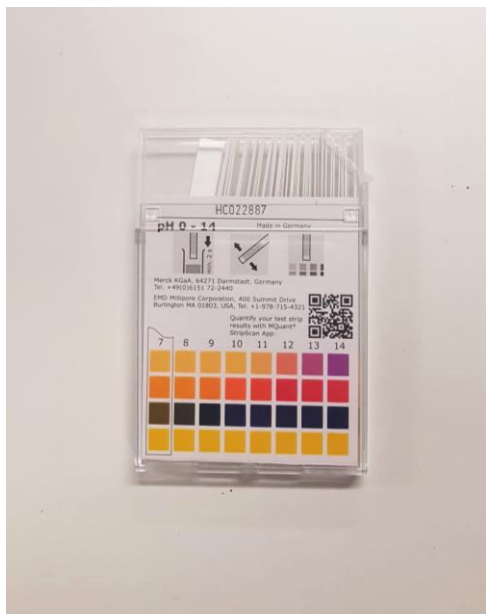
Imagen 55. Tiras reactivas de pH con la escala de color para medir el nivel de pH
