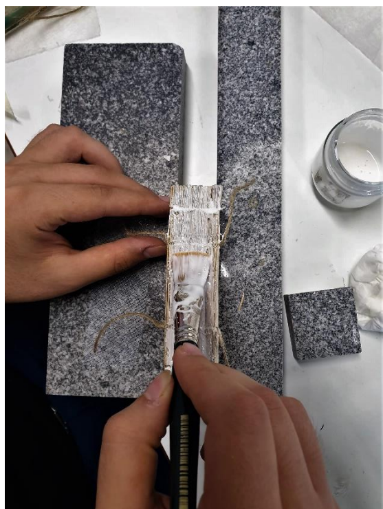
Imagen 68. Aplicando capa de PVA
