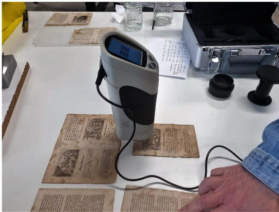
Imagen 58. Realizando pruebas con el colorímetro
