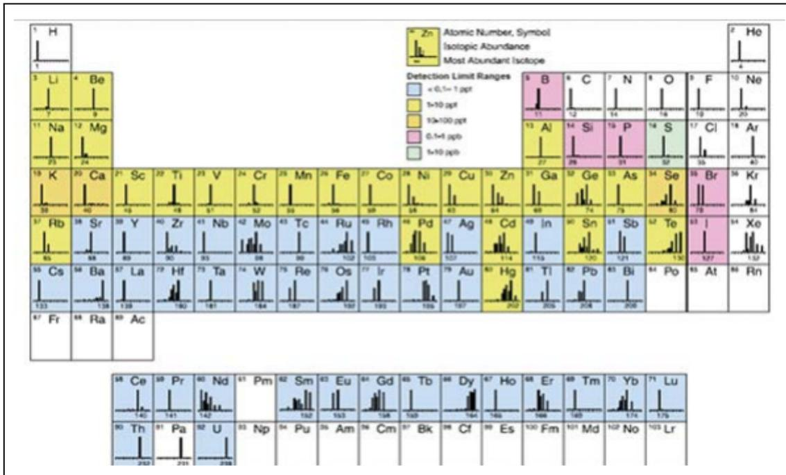
**Figura 3. Elementos que pueden ser analizados por ICP-MS.** Las líneas mostradas para cada elemento en la Figura 3 indican el número y la abundancia relativa del isótopo natural para cada uno o la huella digital isotópica del elemento (Díaz Zamora, 2017; Litter et al., 2009).
