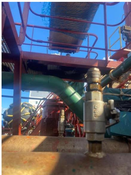
**Ilustración 4:** Pinchazo de aire a las líneas de carga del manifold.
