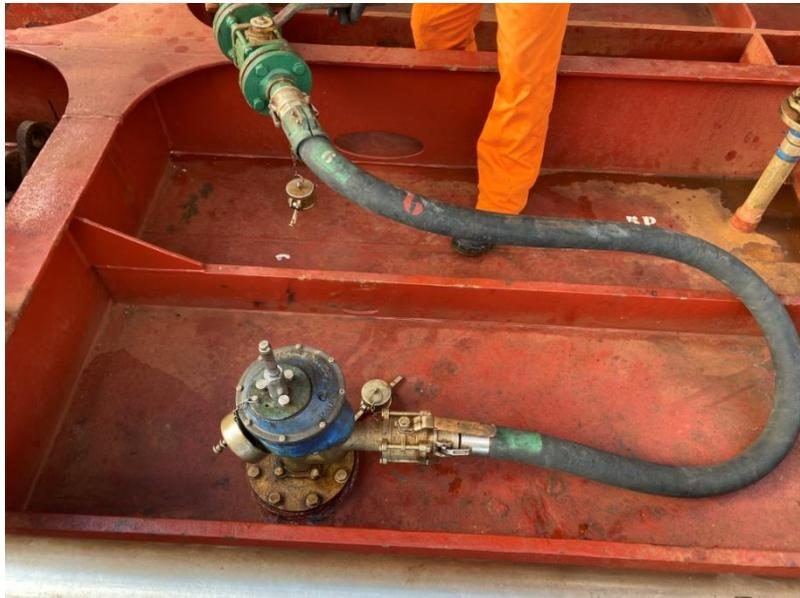
**Ilustración 11:** Maquinilla de limpieza conectada a línea de baldeo.
