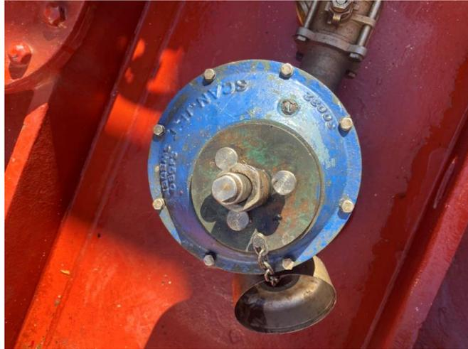
**Ilustración 16:** Maquinilla de limpieza “Scanjet”.
