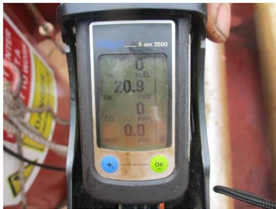
**Ilustración 6:** Explosímetro Dräger.
