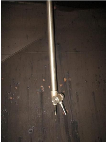
**Ilustración 14:** *Línea de maquinilla de limpieza con una sola tobera giratoria.*
