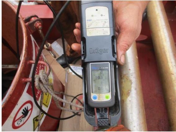
*Ilustración 7: Explosímetro Dräger en funcionamiento.*
