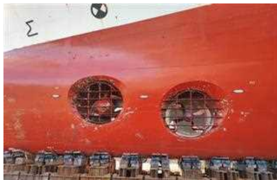
Ilustración 2: Hélices de proa del Volcán de Timanfaya.
