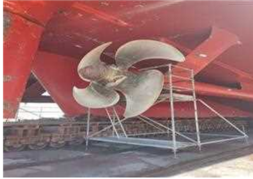
Ilustración 3: Hélice de paso variable del Volcán de Timanfaya.
