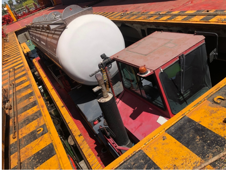
Ilustración 18. Elevador de carga de bodega principal a cubierta. Elaboración Propia.
