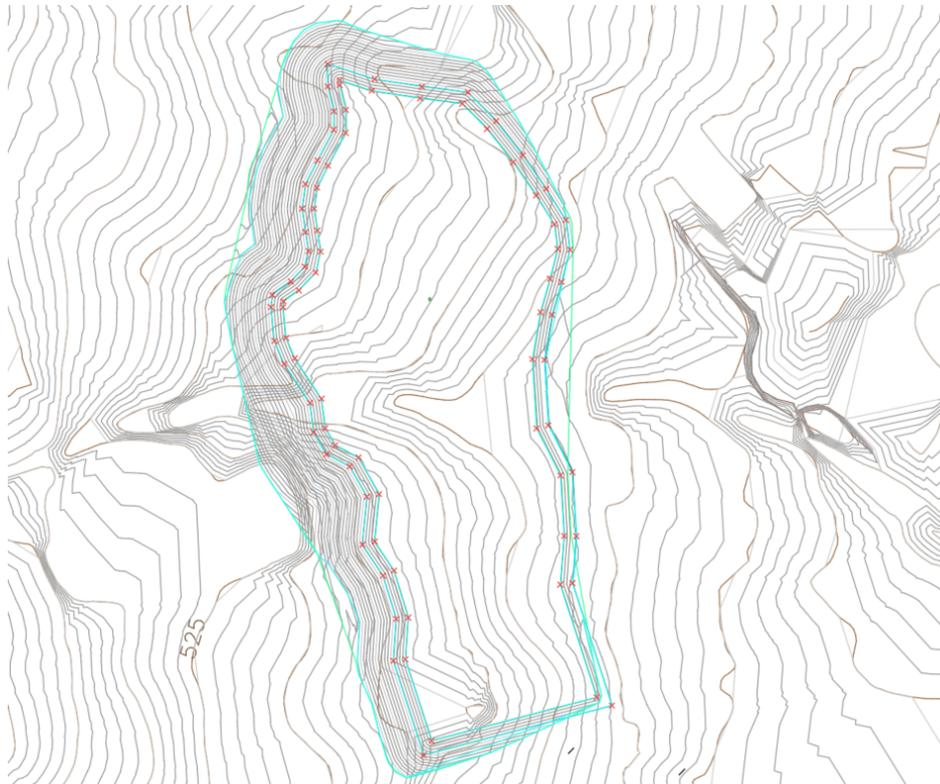
Imagen 1. Localización de los puntos de replanteo sobre la obra.
