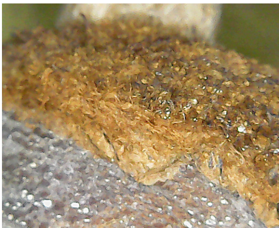
Fig.10.21. Rotura, suciedad y desgaste en un tensor.
