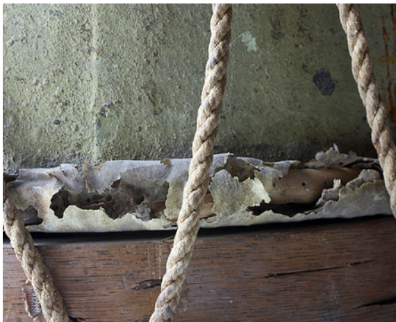
Fig.10.7. Detalle con luz rasante, textura del metal y las lagunas de soporte.
