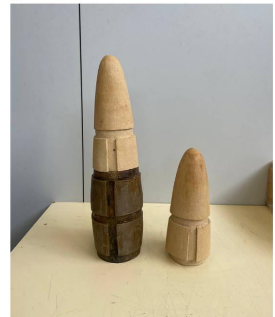
Fig. 60 Prueba de machihembrado, pieza cocida - aún en cera.
