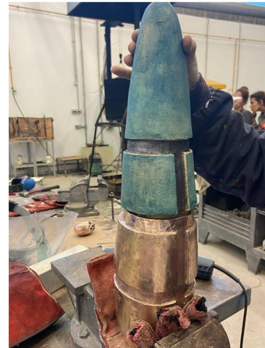
Fig. 63 Prueba de machihembrado, pieza cocida - bronce.
