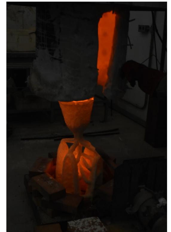
Fig. 38 Fundición por crisol fusible.
