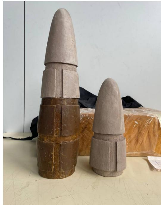
Fig. 54 Prueba de machihembrado, pieza sin cocer.
