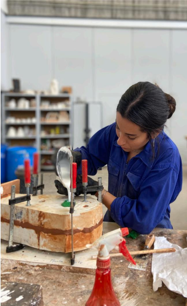
Fig. 27: Realización de moldes de silicona.
