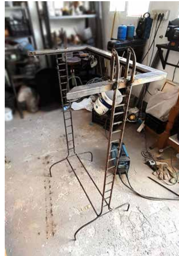
Fig. 222 Unión de la escalera a la piscina
