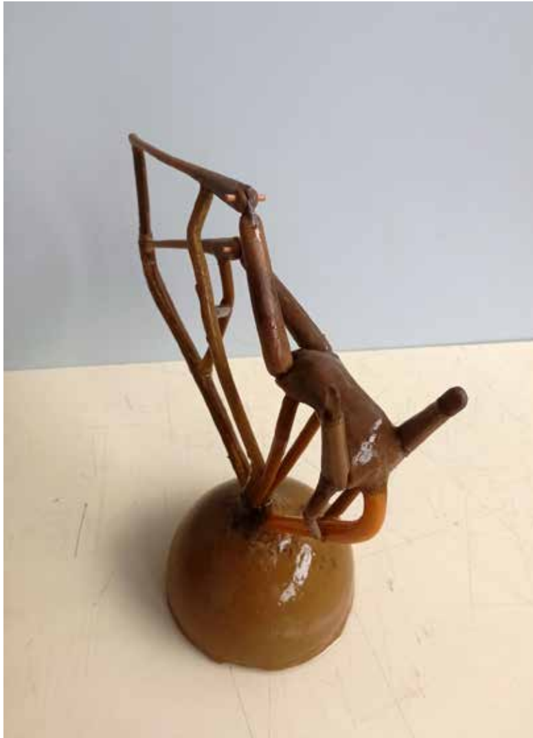
Fig. 137 Soldadura de bebederos
