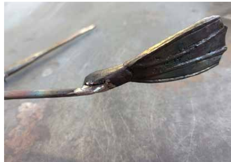
Fig. 195 Aletas preparadas para soldadura
