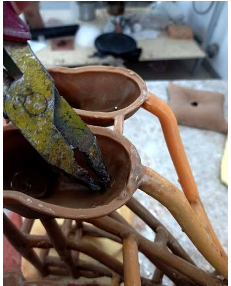
Fig. 118 Colocación de clavo de macho
