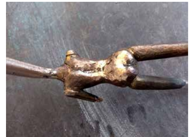
Fig. 183 Repasado de soldadura
