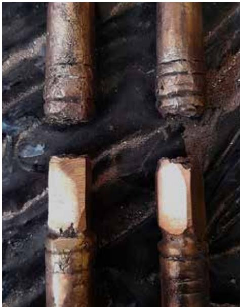
Fig. 177 Quiebre por contracción
