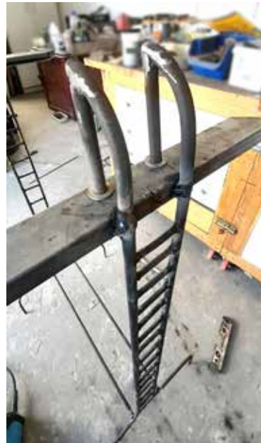
Fig. 219 ; 220 ; 221 Elaboración y unión de los agarres de la escalera
