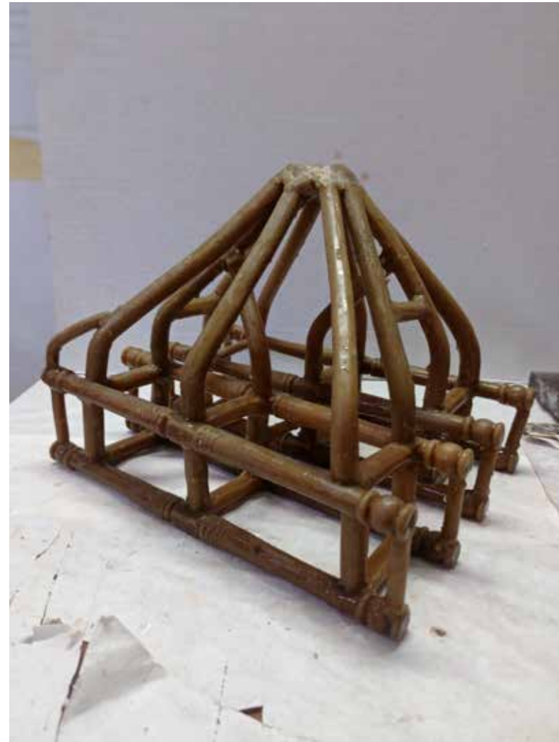
Fig. 133 Soldadura de bebederos árbol cuatro
