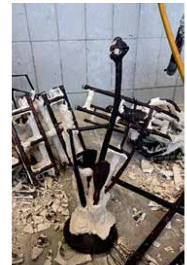
Fig. 172 Descascarillado del metal
