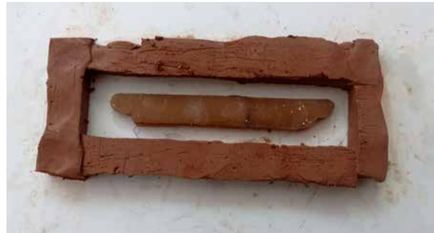
Fig. 72 Tabicados para el molde de viga
