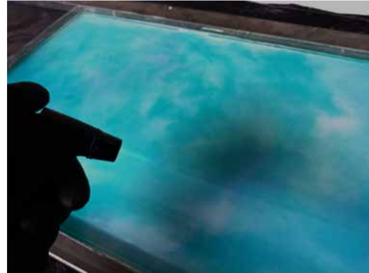
Fig. 207 Eliminación de burbujas con soplete
