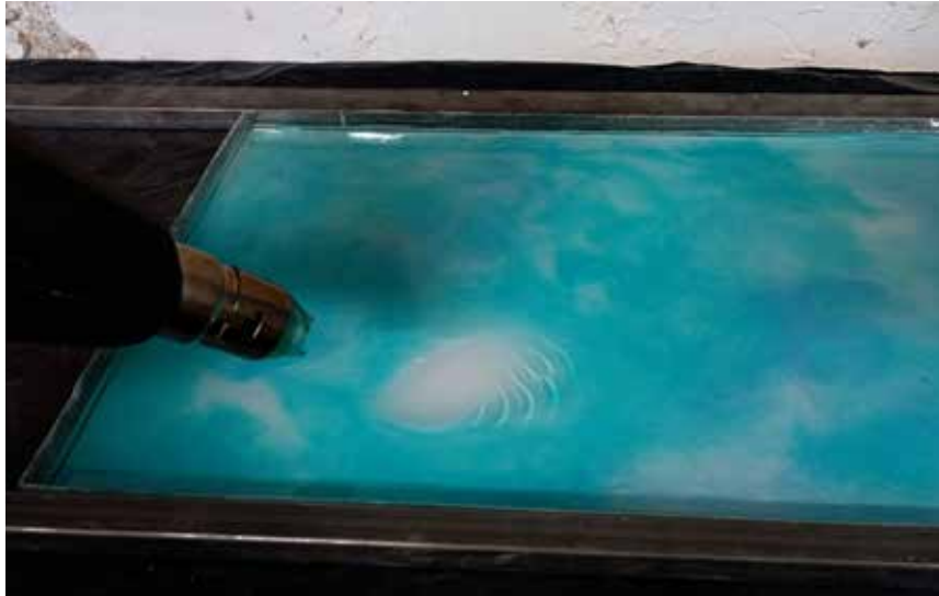
Fig. 208 Aplicación de calor con pistola
