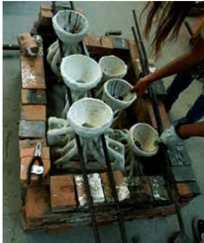
Fig. 163 Colocación de piezas en la mufla
