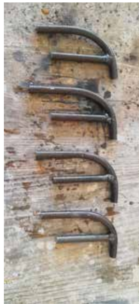
Fig. 219 ; 220 ; 221 Elaboración y unión de los agarres de la escalera
