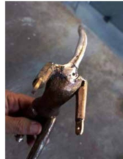
Fig. 181 Repasado de soldadura
