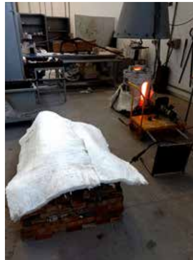
Fig. 167 Horno de mufla tapado con manta cerámica
