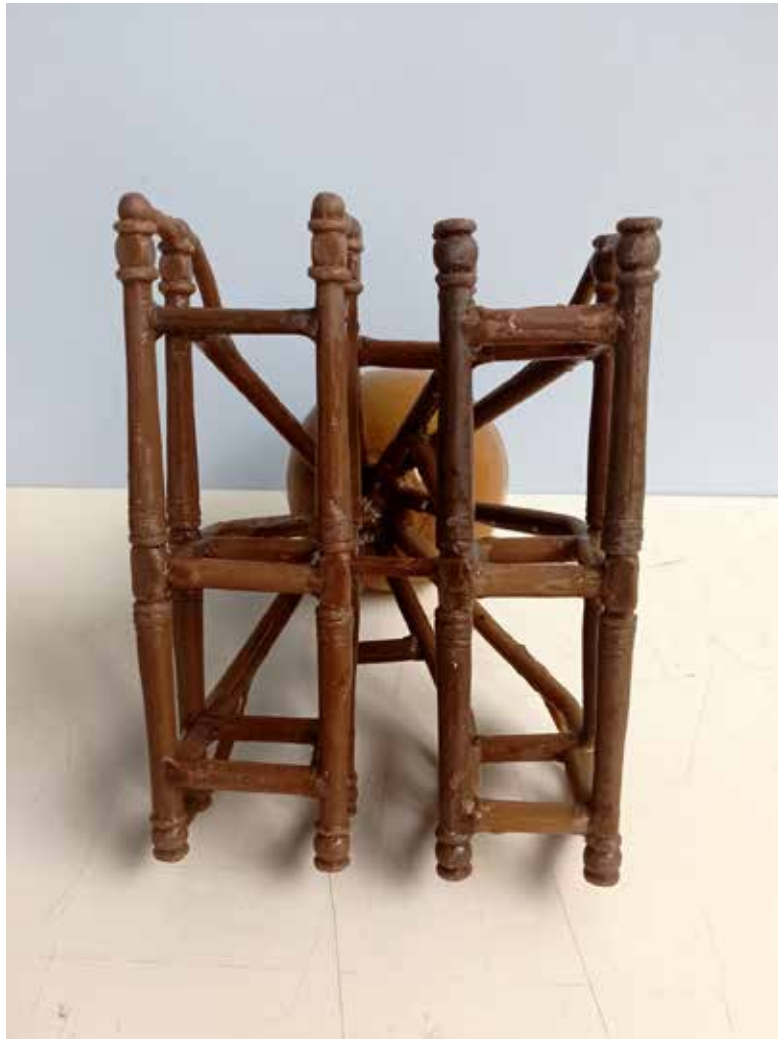
Fig. 132 Soldadura de bebederos árbol cuatro
