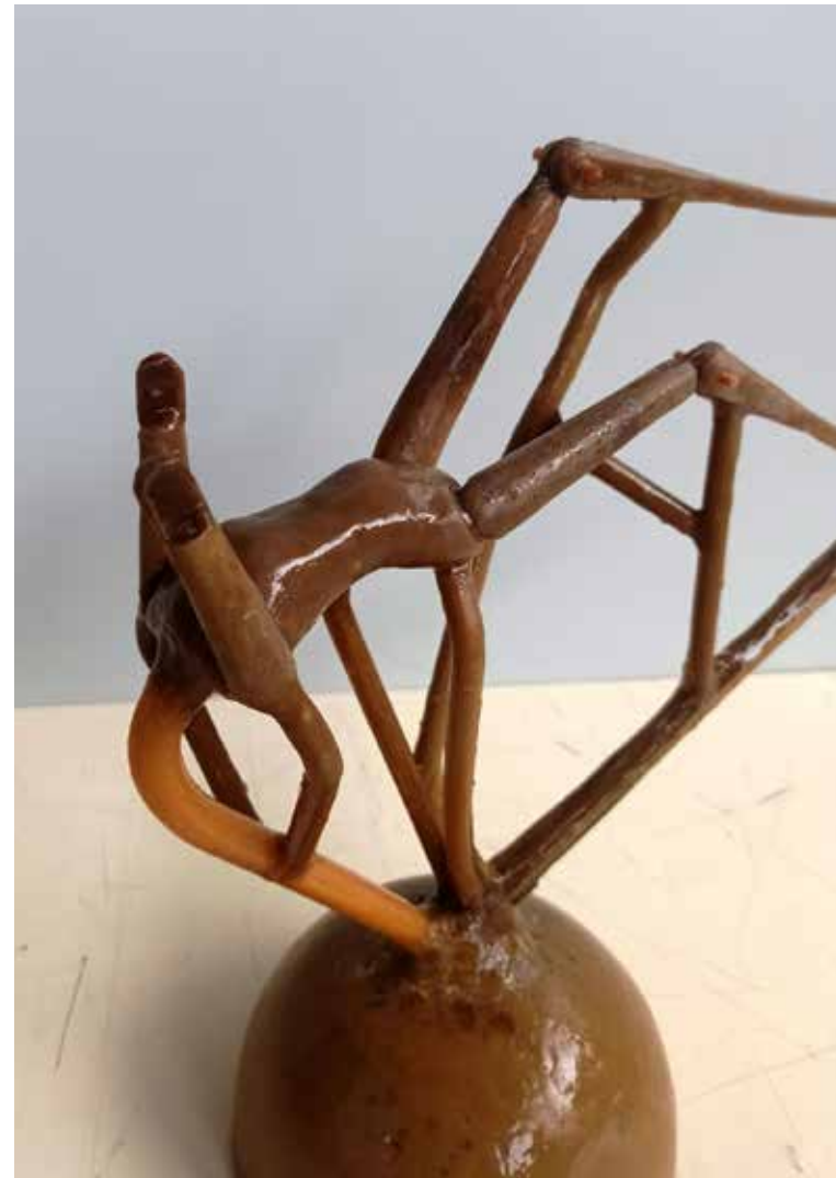
Fig. 138 Soldadura de bebederos
