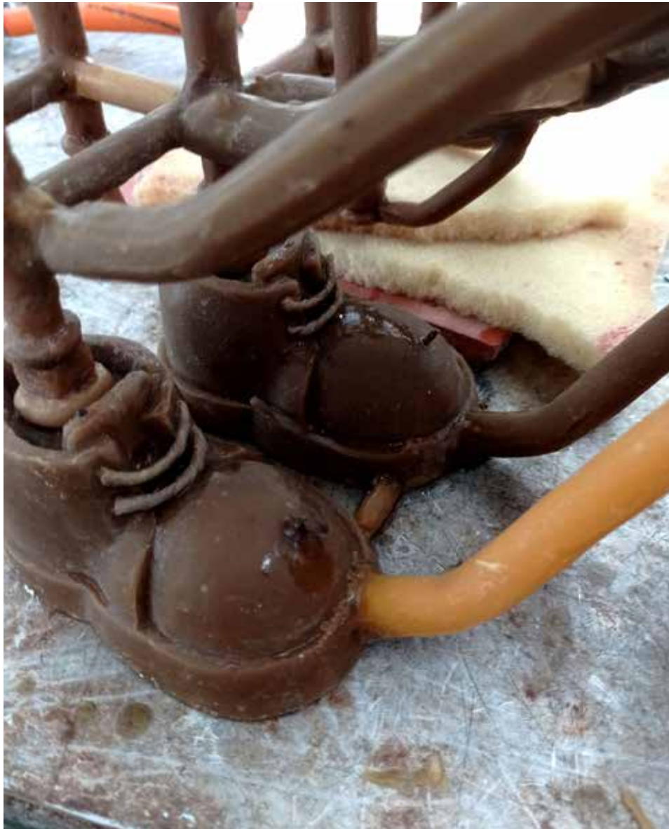
Fig. 117 Sodadura de bebederos
