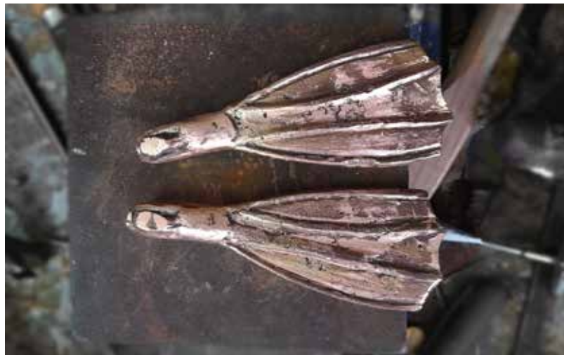
Fig. 194 Reapasado de la soldadura
