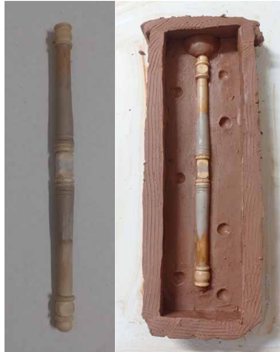
Fig. 74 Construcción del modelo y tabicado para molde
