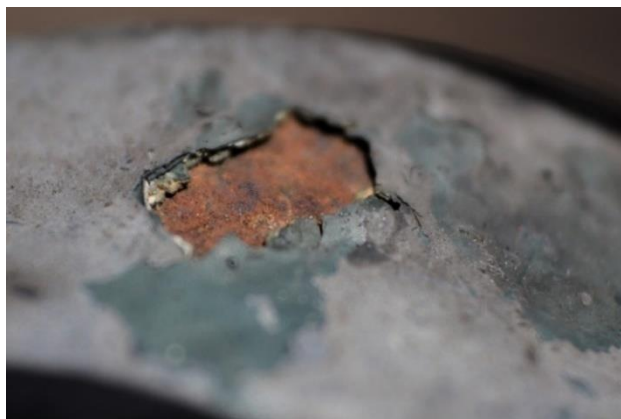
Figura 24. Macrofotografía de oxidación.
