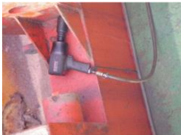
Ilustración 14. Pistola neumática conectada a la manguera que suministraba aire (CIAIM, 2012).
