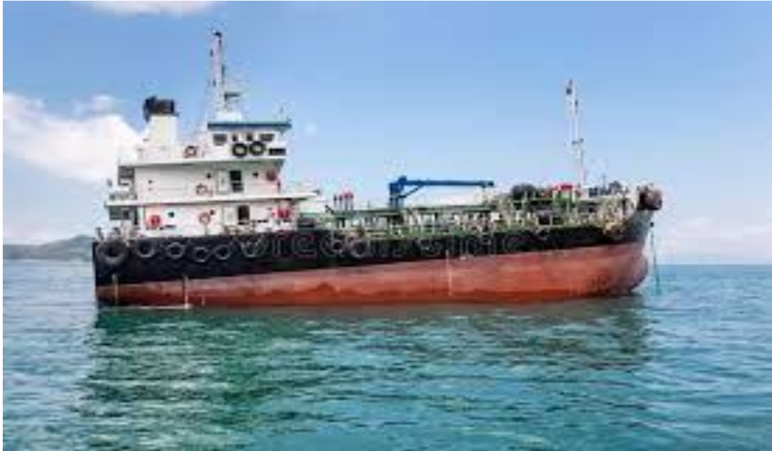
Imagen 10: Coastal Tanker (Costeros): Estos buques tienen capacidad de carga de hasta 16.500 TPM, los mismos son especiales para trayectos cortos.
