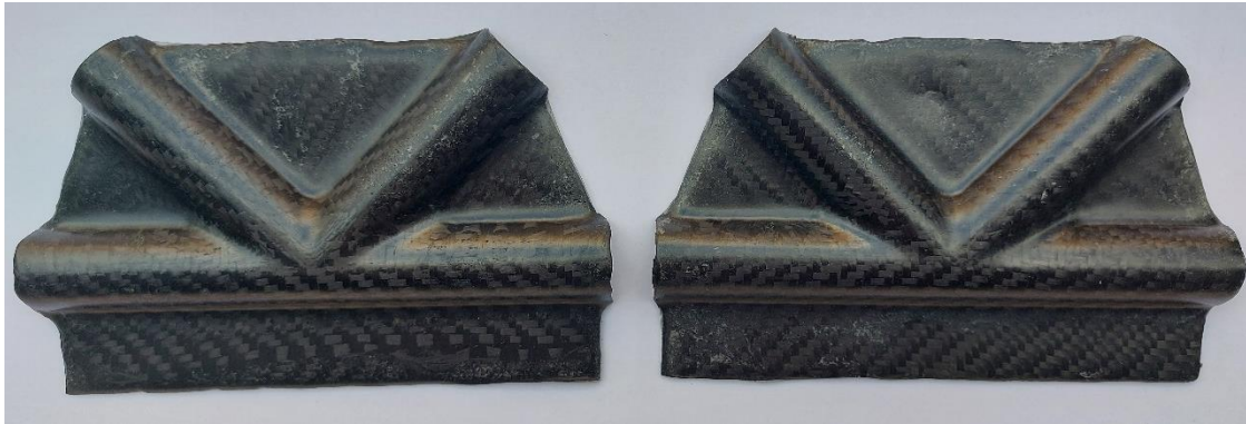
Figura 75: Acabado final de unión por proceso de fabricación 2 (ambas mitades)
