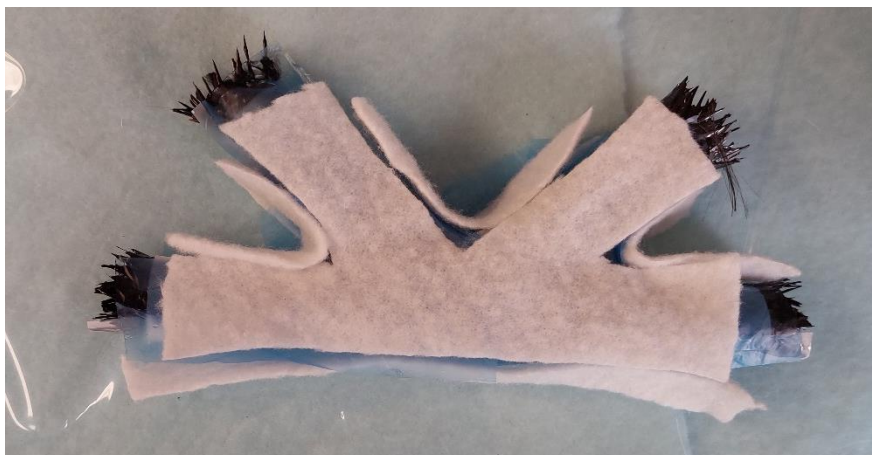
Figura 49: Primera unión con funda - Consumibles colocados sobre el laminado
