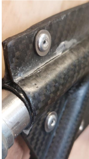
Figura 104: Fisura de la unión 2.3 (ensayo 3)
