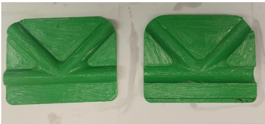
Figura 64: Proceso de fabricación 2 - Moldes modificados sin aleteado preestablecido
