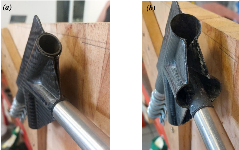
Figura 106: (a) Rotura de la unión 3.1 en el ensayo 3. (b) Rotura de la unión 3.2 en el ensayo 3
