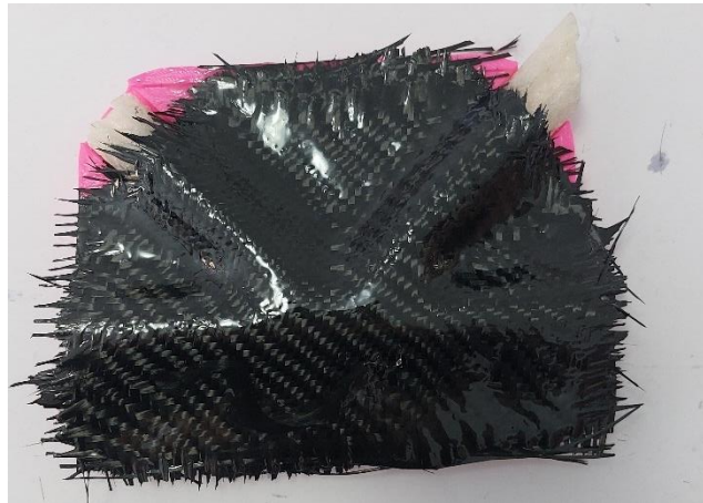
Figura 70: Proceso de fabricación 3 - Laminado de las 4 capas superiores
