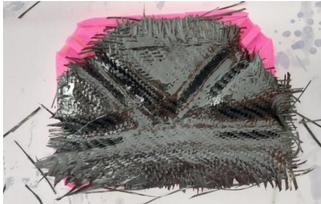
Figura 68: Proceso de fabricación 3 - Primeras 4 capas de tela
