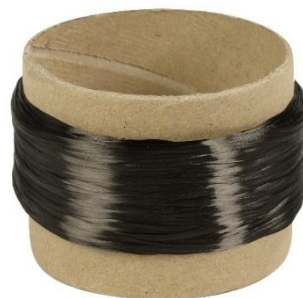
Figura 6: Fibra de carbono (hilo) 3K (Fuente: Easy Composites)
