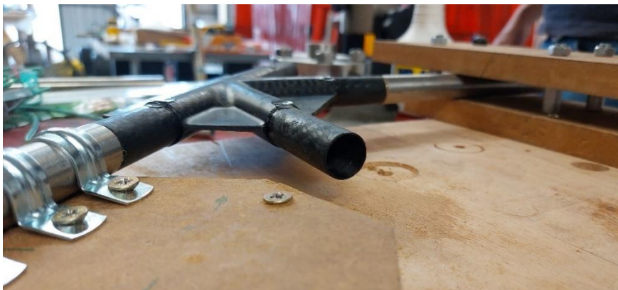
Figura 86: Unión separada de la madera y guías del brazo de carga
