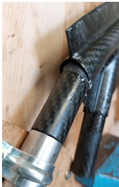
Figura 98: Rotura del adhesivo en la unión 3.2
