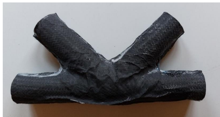
Figura 52: Primera unión con funda - Acabado superficial 2
