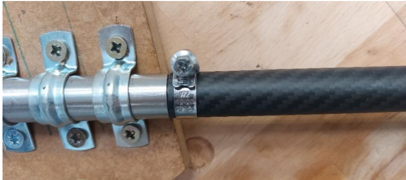
Figura 100: Abrazadera para evitar el ovalamiento de la sección
