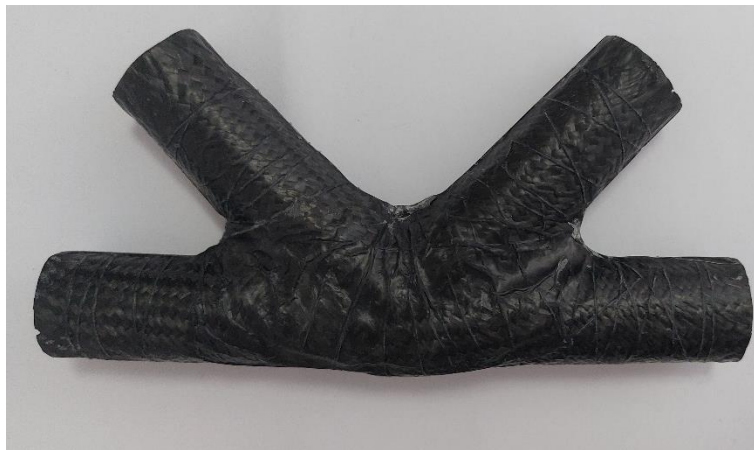
Figura 55: Segunda unión con funda - Acabado superficial
