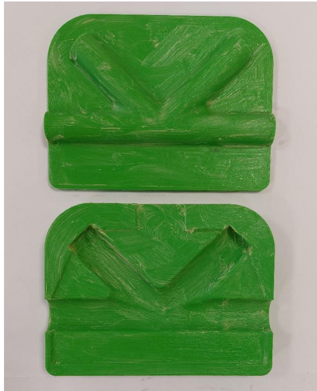
Figura 58: Proceso de fabricación 2 – Molde con desmoldeante aplicado
