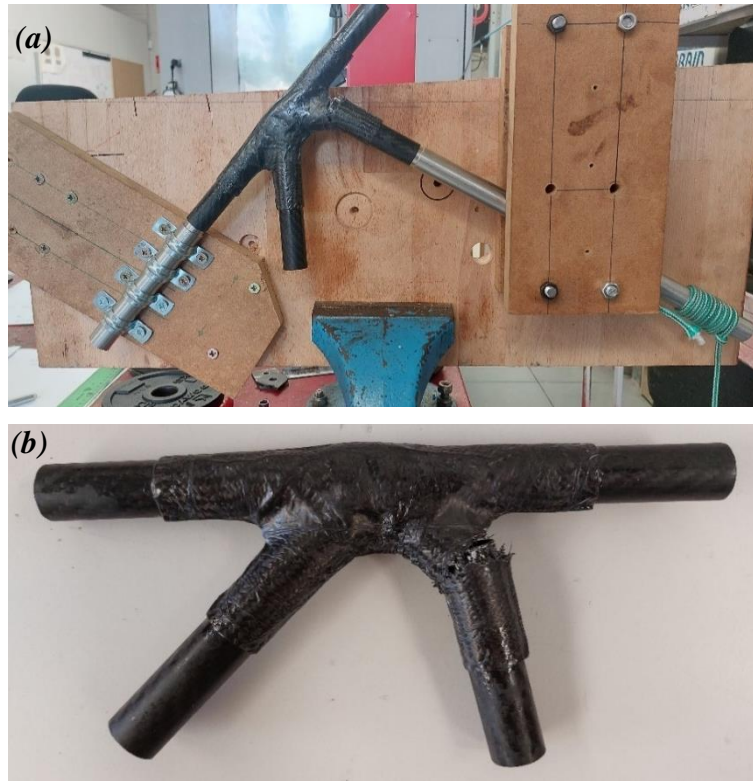
Figura 91: Rotura de probeta 1.2. (a) En dispositivo de ensayo. (b) Posterior al ensayo
