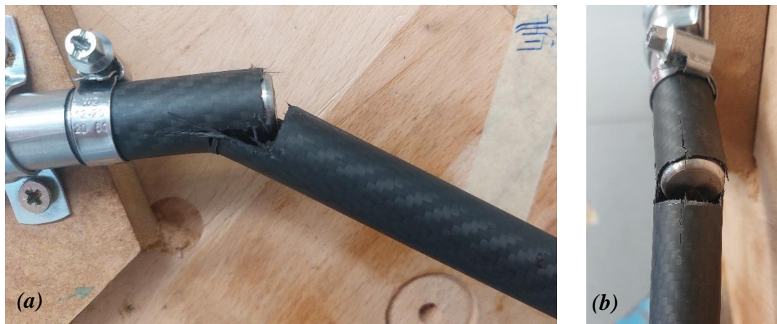
Figura 102: Rotura de uno de los tubos de ensayo. (a) Vista frontal. (b) Vista lateral
