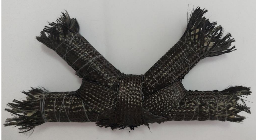
Figura 47: Primera unión con funda - Primera capa y refuerzos
