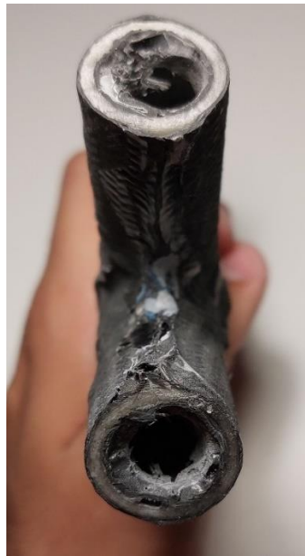
Figura 53: Primera unión con funda - Aleta perimetral formada
