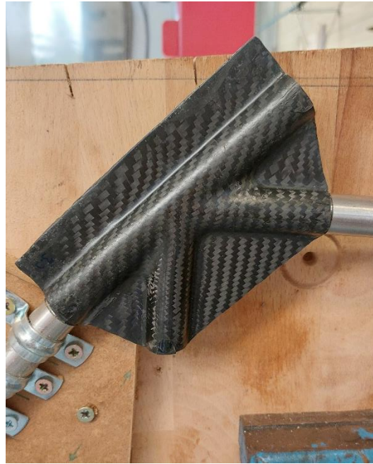
Figura 107: Unión 3.3 con toda la carga aplicada en el ensayo 3
