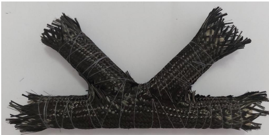
Figura 46: Primera unión con funda - Primera capa
