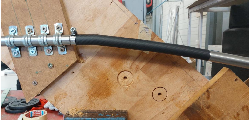
Figura 101: Fallo alcanzado en 3 de los ensayos en tubos
