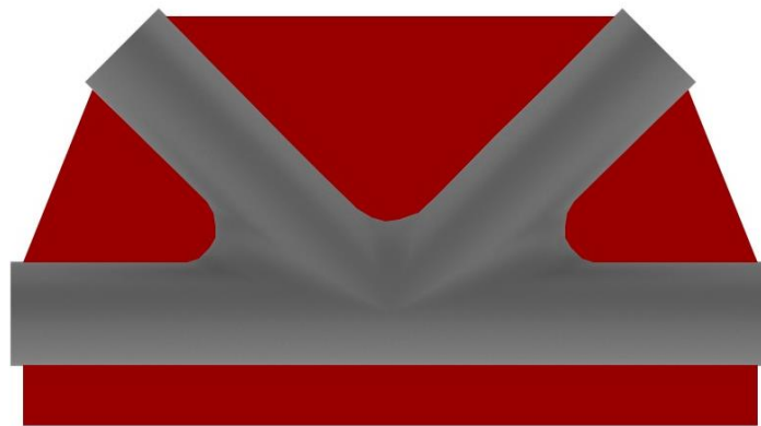
Figura 17: Cartelas que se dejarán en el contorno de la geometría (en rojo)
