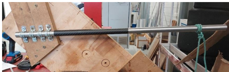
Figura 99: Dispositivo de ensayo de resistencia del tubo
