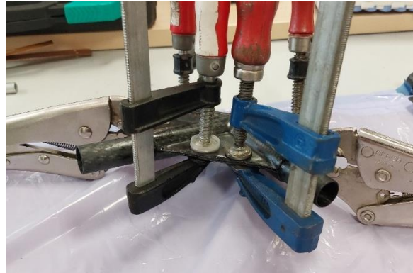
Figura 78: Pegado de la unión mediante sargento (1)
