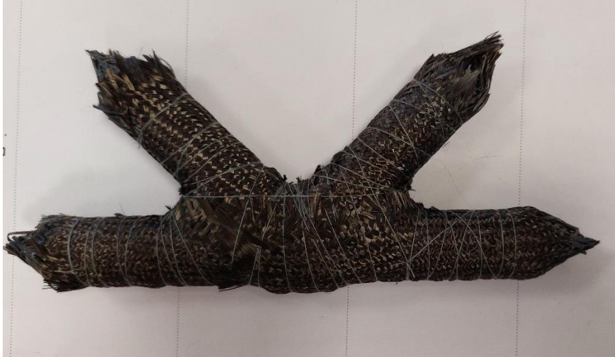
Figura 54: Segunda unión con funda - Capas exteriores
