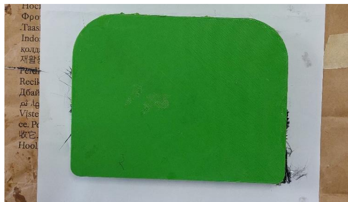
Figura 60: Proceso de fabricación 2 - Molde cerrado con el laminado en el interior
