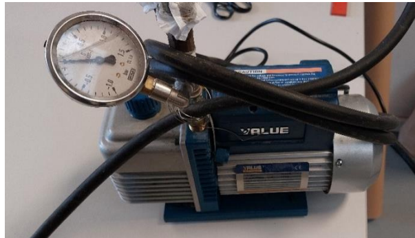
Figura 32: Bomba de vacío empleada en el proyecto
