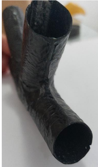
Figura 56: Segunda unión con funda – Contorno de la unión
