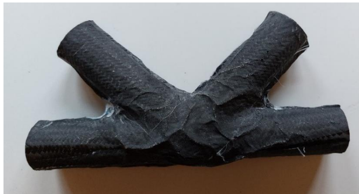
Figura 51: Primera unión con funda - Acabado superficial 1
