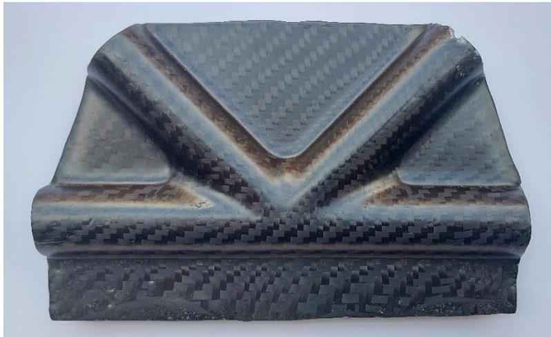
Figura 76: Acabado final de unión por proceso de fabricación 3
