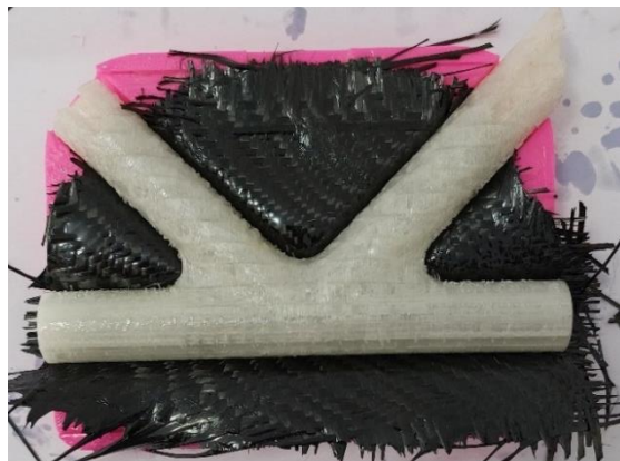
Figura 69: Proceso de fabricación 3 - Introducción del núcleo en el laminado
