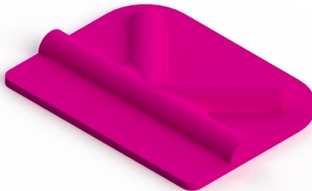
Figura 19: Tapa para el molde negativo
