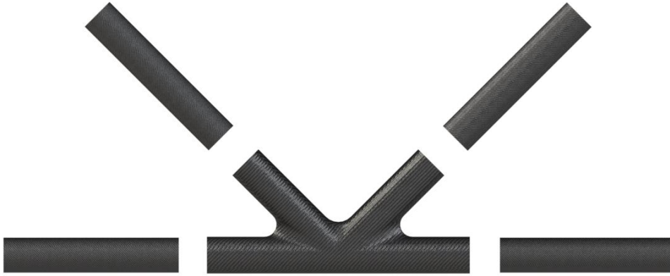
Figura 1: Idea de la unión llevada a cabo
