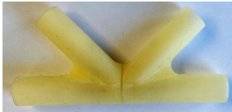
Figura 44: Proceso 1 - Núcleo a laminar
