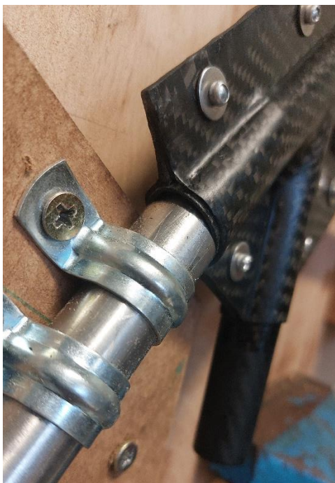
Figura 103: Ovalamiento de la sección en unión 2.2 (ensayo 3)
