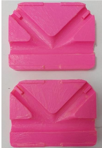
Figura 67: Proceso de fabricación 3 - Molde y contramolde con desmoldante
