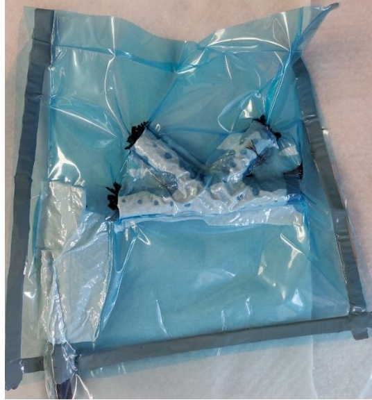
Figura 50: Primera unión con funda - Unión a vacío
