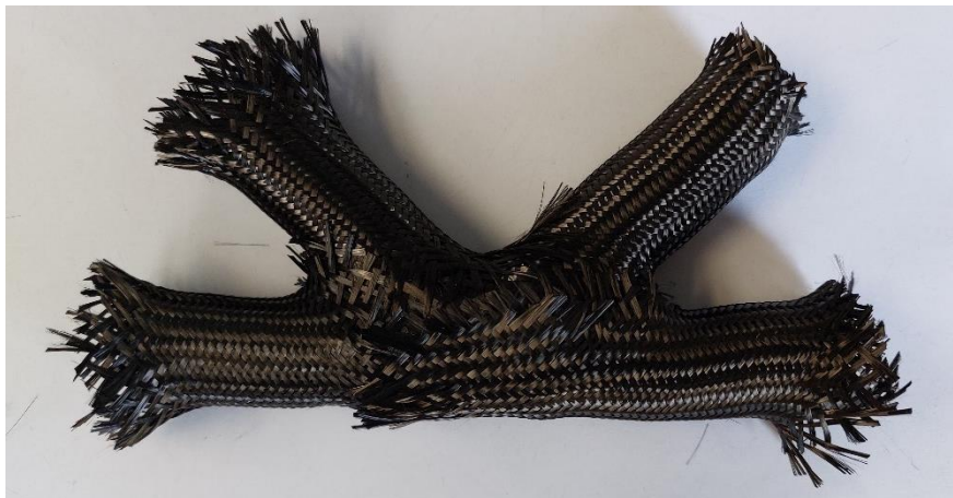
Figura 48: Primera unión con funda - Aspecto final de las capas de fibra de carbono
