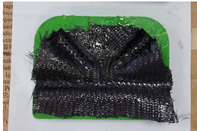
Figura 59: Proceso de fabricación 2 - Tejido de carbono y resina depositadas en el molde
