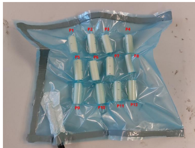
Figura 37: Probetas sometidas a vacío
