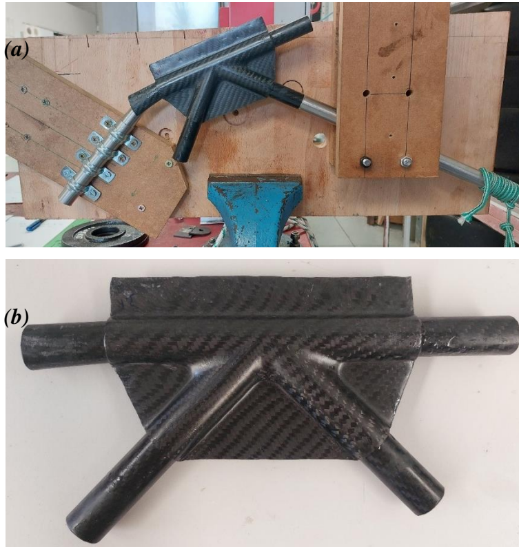
Figura 95: Rotura de probeta 3.1. (a) En dispositivo de ensayo. (b) Posterior al ensayo
