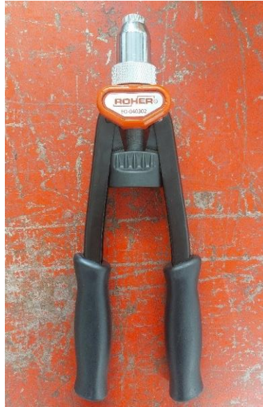
Figura 81: Remachadora manual utilizada
