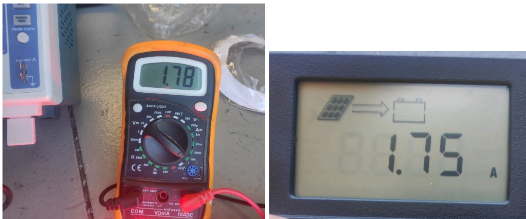
Figura 2.10 Lectura de intensidad por los diferentes equipos durante la carga de la batería
