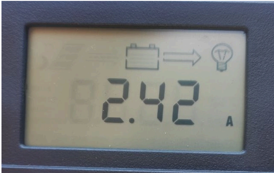
Figura 2.11 Intensidad consumida durante un ciclo de descarga
