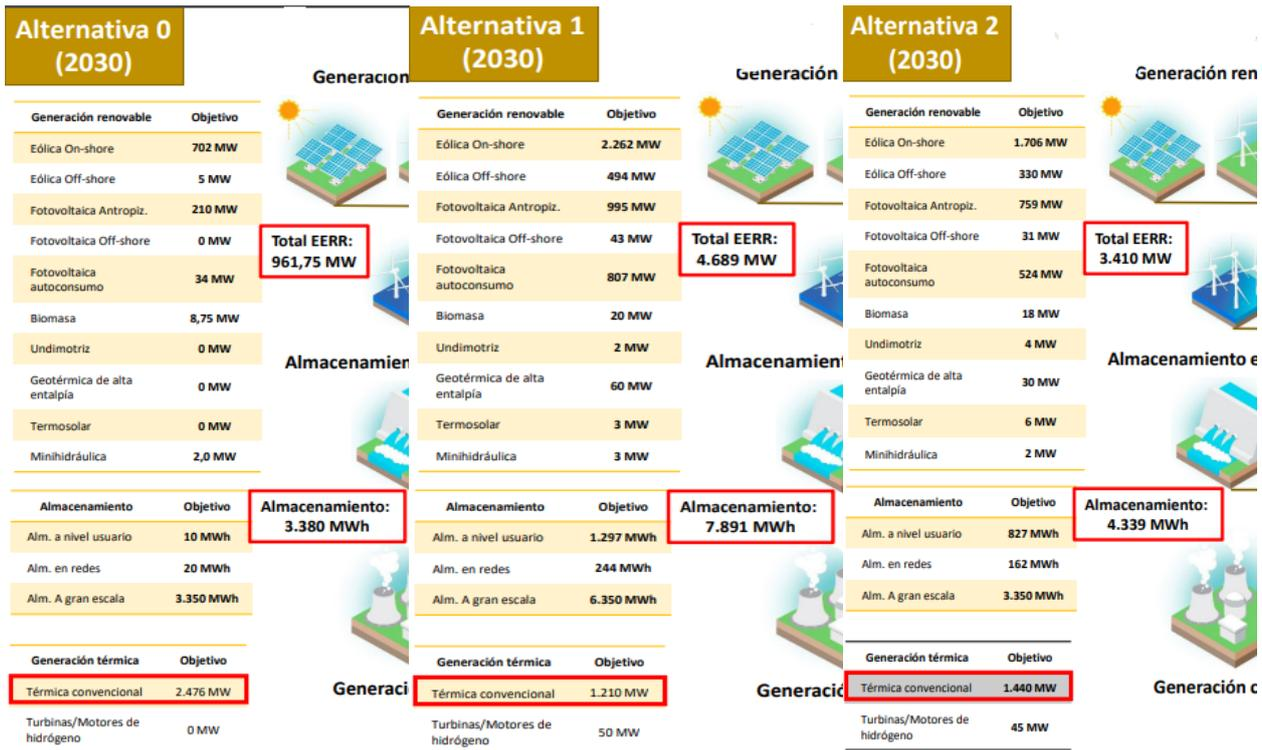
Figura 11. Producción y almacenamiento de energía según las alternativas del PTEC [7].
