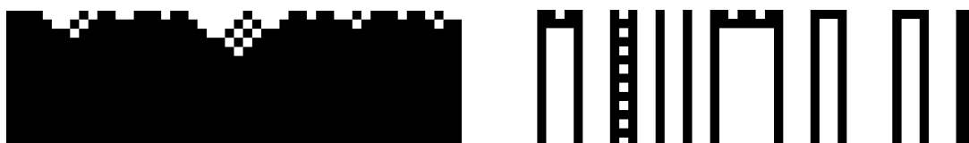
Figura 1.6: Regla 250 a la izquierda y regla 108 a la derecha. Ambas comenzando de una configuración inicial aleatoria. Para ambas reglas el patrón generado muestra cierta organización. La regla 250 evoluciona hacia un patrón uniforme de todas las celdas negras. La regla 108 se ordena en estructuras locales estáticas o periódicas.
