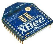
**Figura 2.2 Módulo XBee utilizado**
