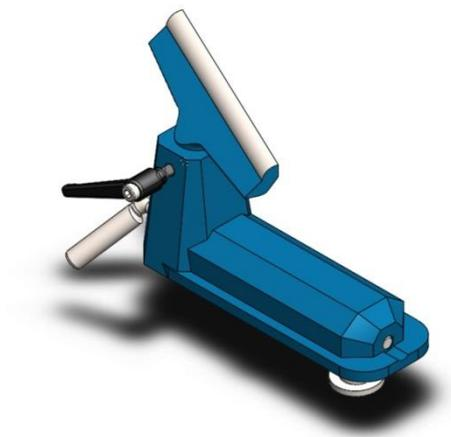
**Figura 21. Apoya-herramientas del torno. Fuente Propia**
