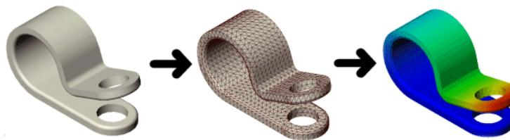
**Figura 8. Proceso para simular mediante el MEF en SolidWorks®. Fuente: help.solidworks.com**
