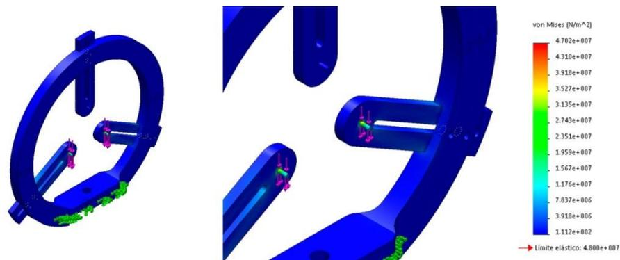
Figura 40. Resultados de deformada de la luneta – esfuerzos con PLA. Fuente Propia
