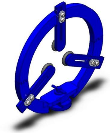
**Figura 37. Luneta para el torno**
