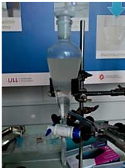
*Figura 4.18.- Lavados con H<sub>3</sub>PO<sub>4</sub> al 3% y agua caliente.*
