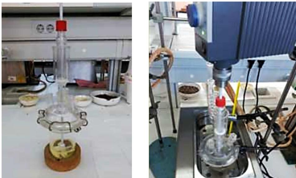
*Figura 4.14.- Sistema de reacción para la esterificación.*
