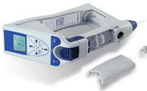
*Figura 4.12.- Densímetro digital portátil.*
