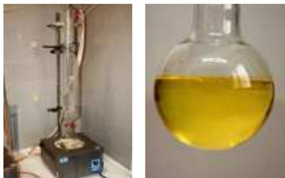
*Figura 4.9.- Dispositivo de recuperación de hexano/ Balón con aceite de Jatropha extraído.*
