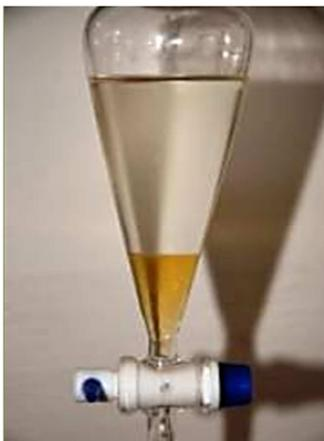
*Figura 4.17.- Productos de la reacción de transesterificación transcurridas 24 horas, la capa inferior es glicerina y la capa superior es biocombustible.*
