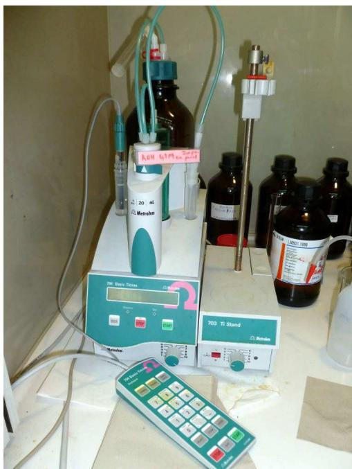
*Figura 4.11.- Valorador automático para el índice de acidez (Metrohm modelo Titrino 794)..*
