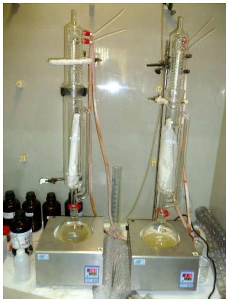
*Figura 4.6.-Dispositivo de extracción de aceite.*
