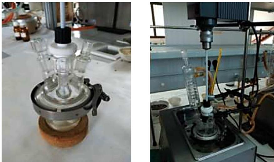
*Figura 4.16.- Sistema de reacción para la transesterificación.*
