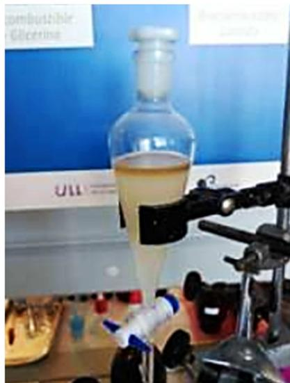
*Figura 4.15.- Decantación del aceite esterificado.*
