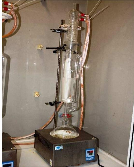
*Figura 4.6. Equipo de extracción*
