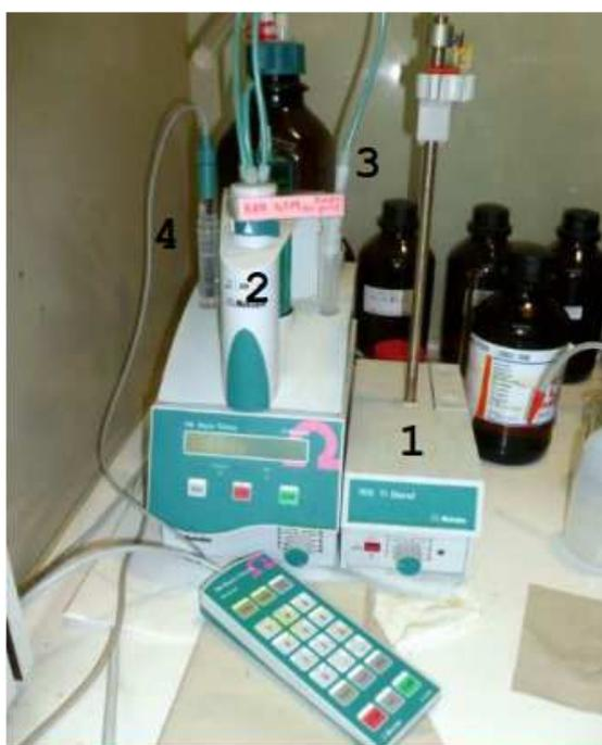
*Figura 4.22. Valorador automático Metrohm*
