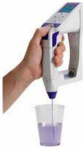
**Figura 4.23. Densímetro Meter Toledo**
