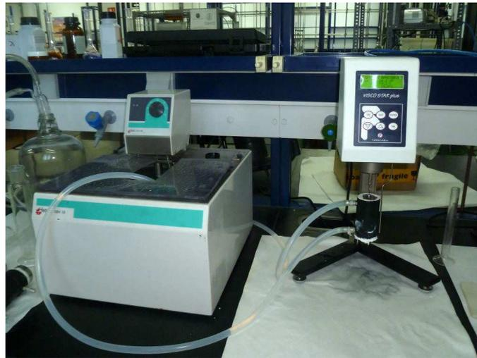
*Figura 4.24. Viscosímetro rotacional VISCO STAR plus L*
