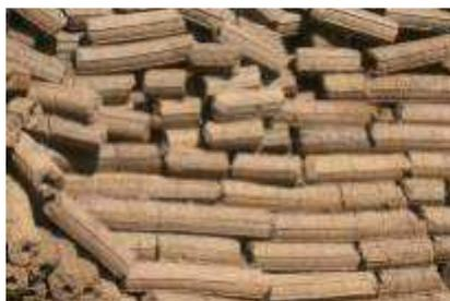
*Figura 2.8. Briquetas presadas de torta de semillas de Jatropha*
