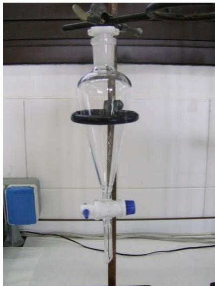
*Figura 4.12. Embudo de decantación*
