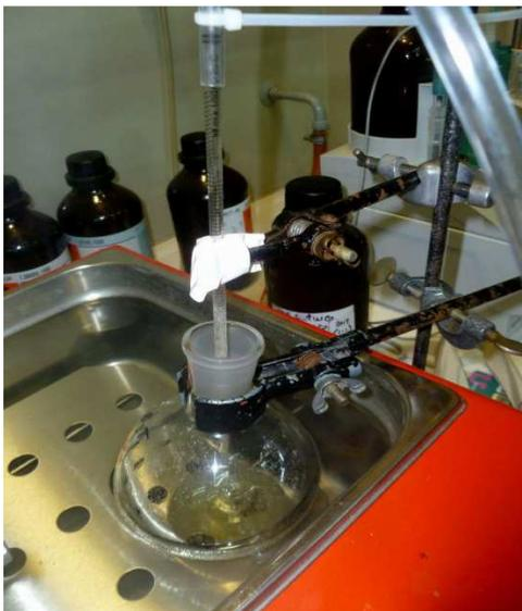
**Figura 4.10. Burbujeo con nitrógeno**
