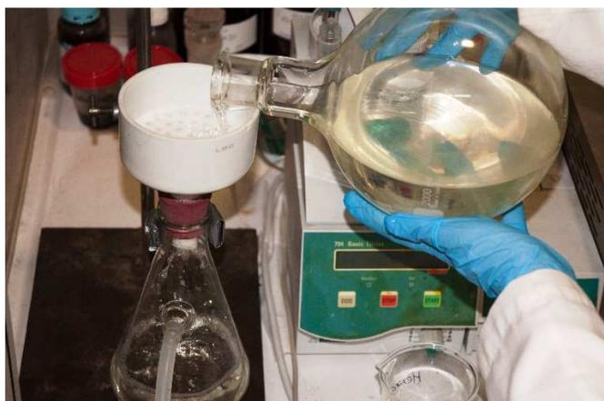
**Figura 4.8. Filtración a vacío**
