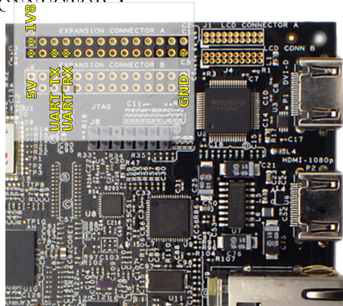
Figura 3.1: Descripción de pines necesarios para conectar el adaptador XBee
