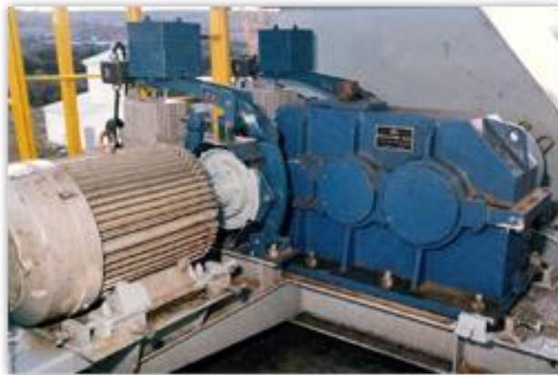
Figura 2: “Ilustración de una caja reductora para grúa”. Fuente: KRONECRANES
