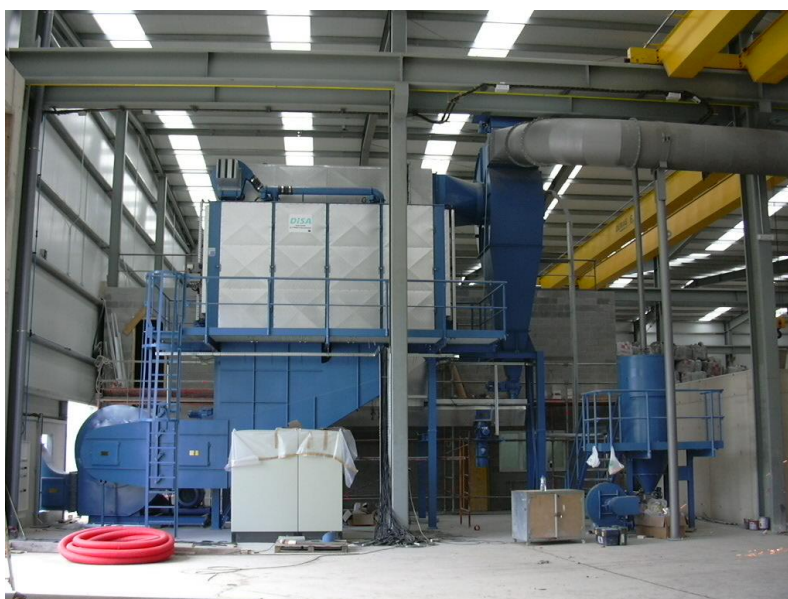
Fig 7: Sistema de Aspiración y Filtración de Humos
