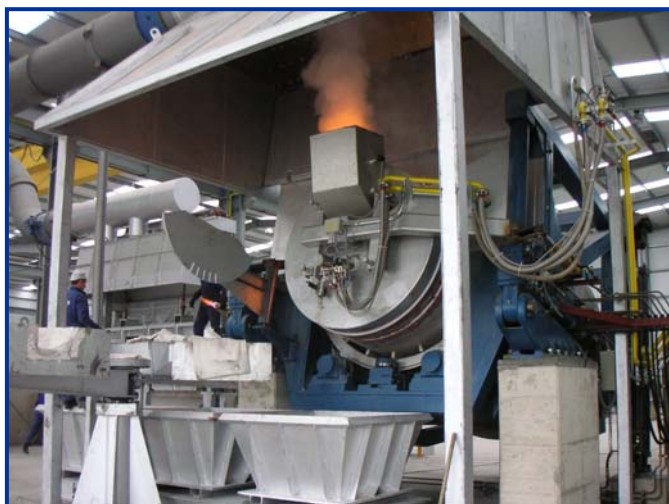
Instalación completa Rotativo FARB-12, con puerta, retenedor, reguera móvil y carro recogida escorias
