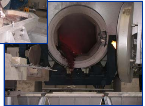
FARB con la puerta abierta y extracción escoria salina en carro de cestones
