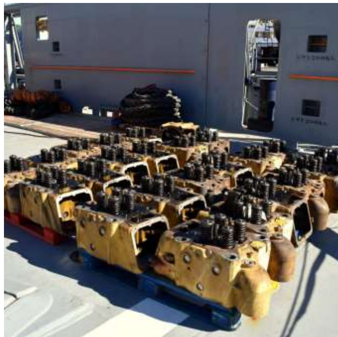
Ilustración 27. Culatas. Fuente: www.caterpillar.com
