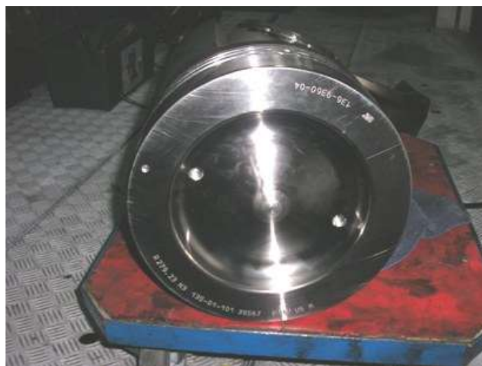
Ilustración 26. Cabeza pistón. Fuente: Trabajo de campo
