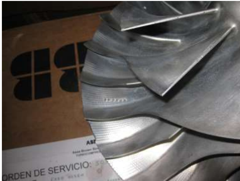
Ilustración 44. Detalle del compresor del Turbo. Fuente: Trabajo de campo
