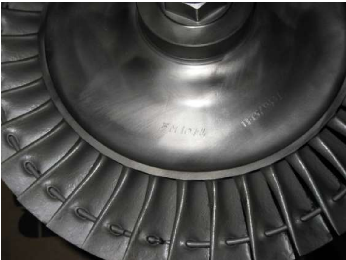
Ilustración 45. Detalle de la turbina del turbo. Fuente: Trabajo de campo
