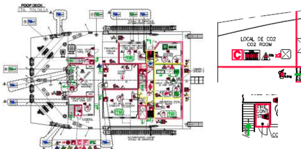
Ilustración 16. Disposición local de CO2. Fuente: Plano contra incendios del buque.
