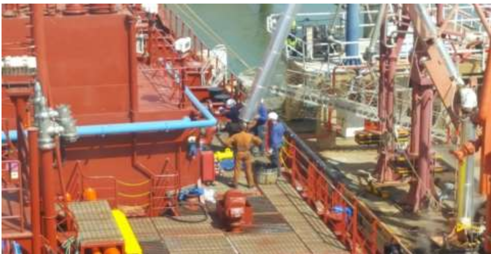
Ilustración 49. Conexión del manifold previo a las operaciones de carga en la terminal de Tarragona. Fuente: Plano del sistema.
