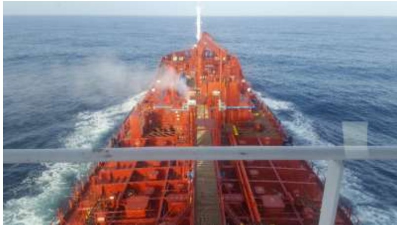
Ilustración 58. Válvula PV del tanque 3Er liberando presión de los gases desprendidos por la carga durante la navegación. Fuente: Elaboración propia.
