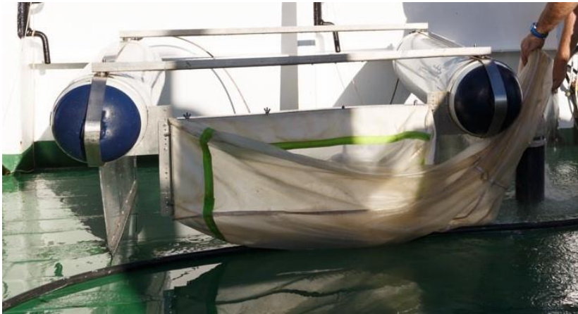
Fig. 17: Patín con red Neuston. Fuente: Elaboración propia
