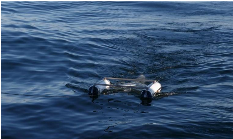
Fig. 18: Patín con red Neuston. Fuente: Elaboración propia
